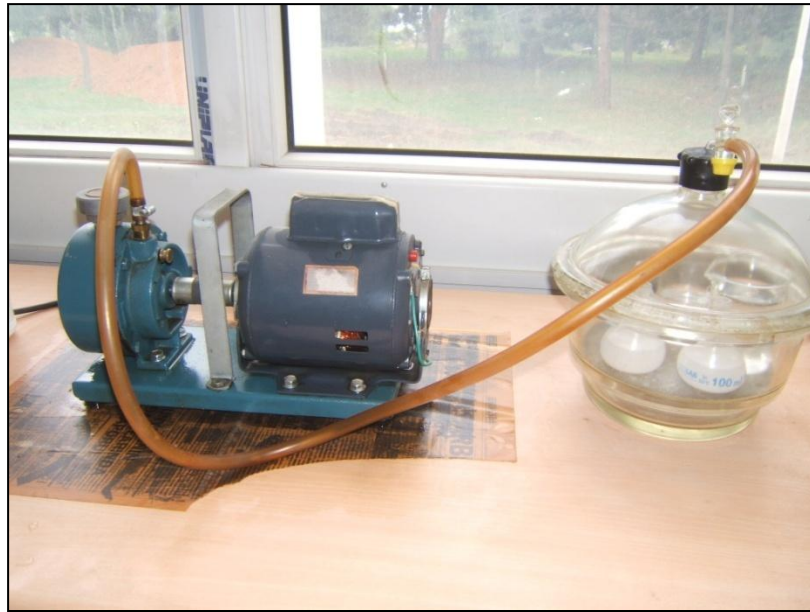
Şekil 2.2. Piknometre deney düzeneği
