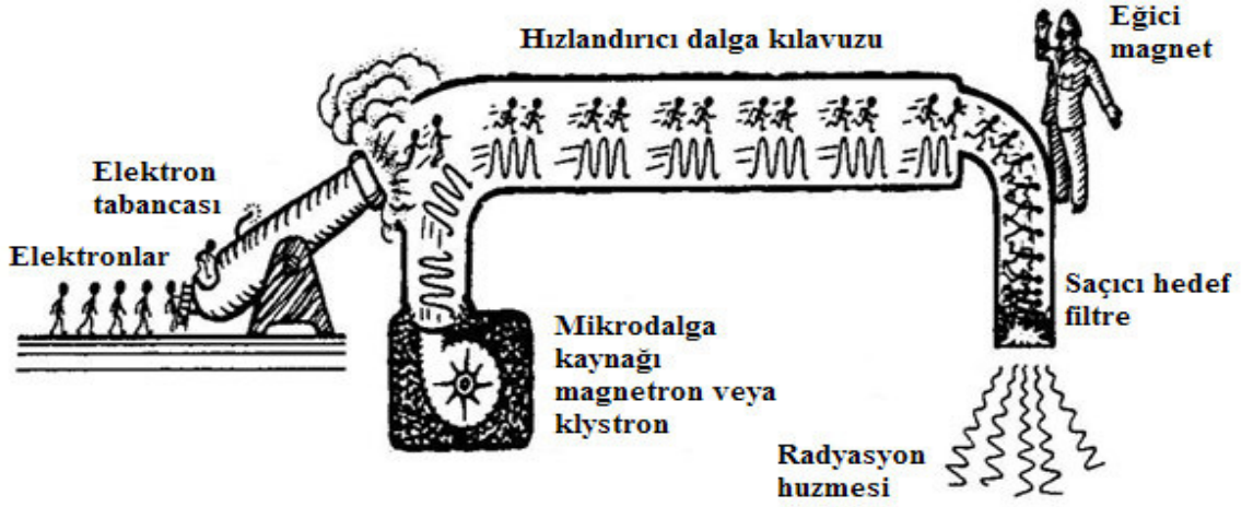
Şekil 2.1. Lineer hızlandırıcının şematik yapısı
