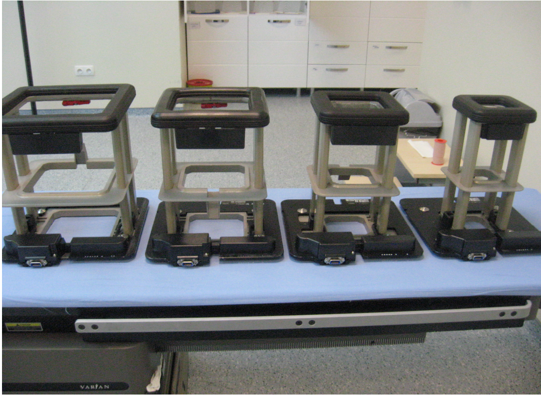
Şekil 3.5. 25x25 cm, 20x20 cm, 15x15 cm, 10x10 cm boyutlarındaki Standart Elektron Aplikatörleri
