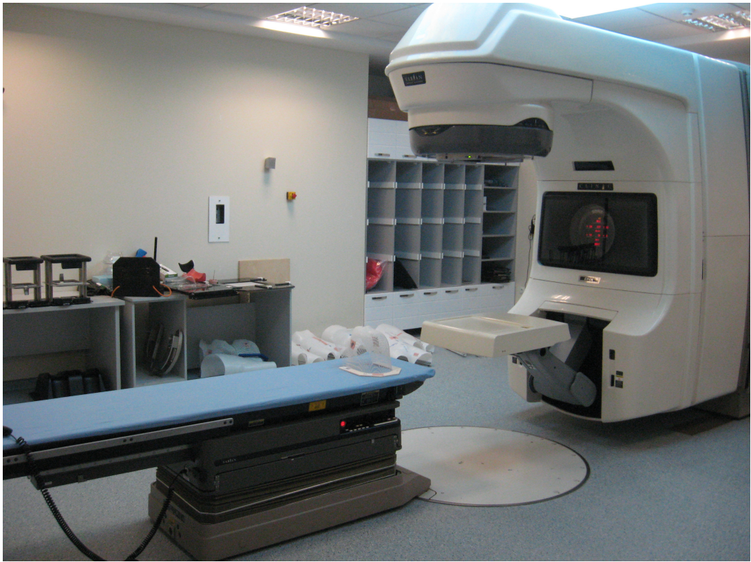
Şekil 3.1. VARIAN Clinac DHX Lineer Hızlandırıcı Cihazı
