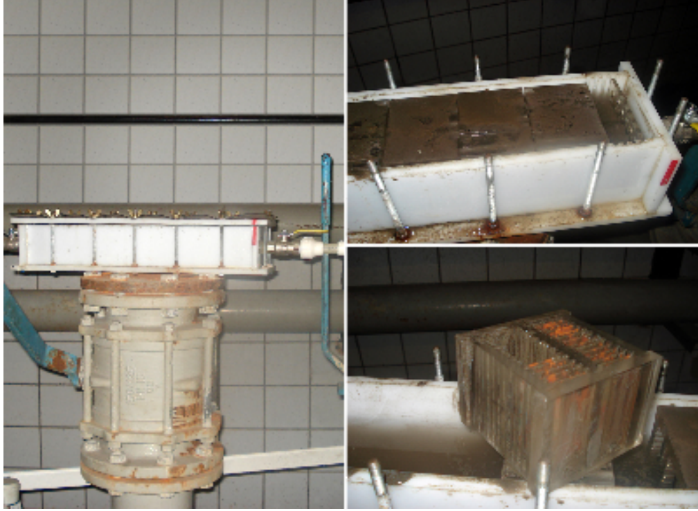
řekil 3.2: Soęutma sisteminin ısı deęiřtiricisine paralel olarak baęlanan bakır kuponların yerleřtirildięi deney düzeneęi
