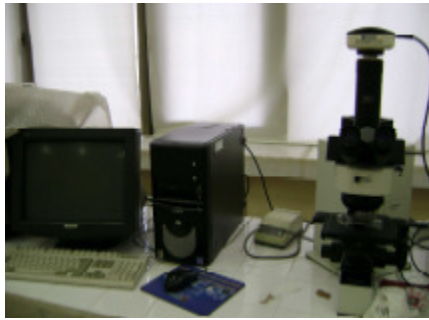
Resim.3.14 Basit polarize filtrelili optik mikroskop
