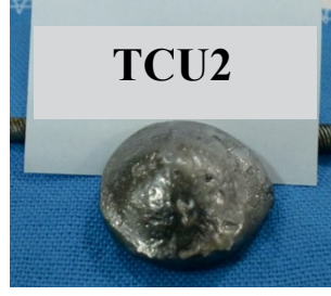
Resim.3.2 Ön ergitme işlemi tamamlanmış master alaşım numunesi (30-60gr)
