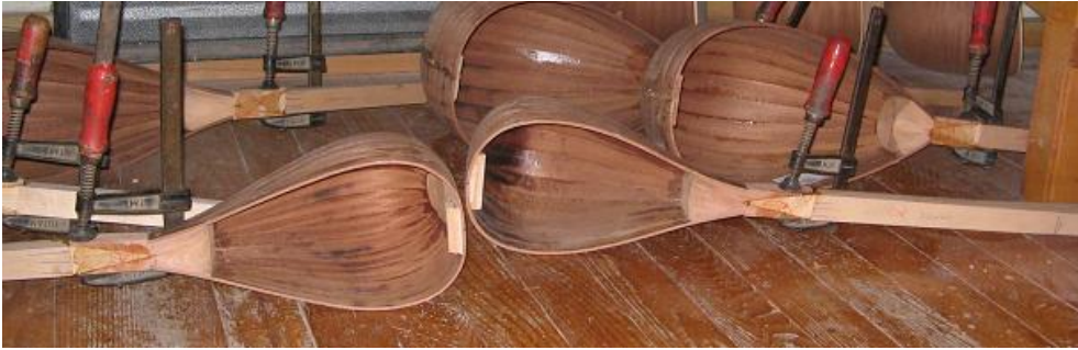
Resim 2.11 : Kurtağzı yöntemi ile montajı yapılan klavyeler
