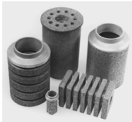
Şekil 2.9 Katı hal yöntemiyle üretilmiş metal köpük parçalar (Banhart, 2001)
