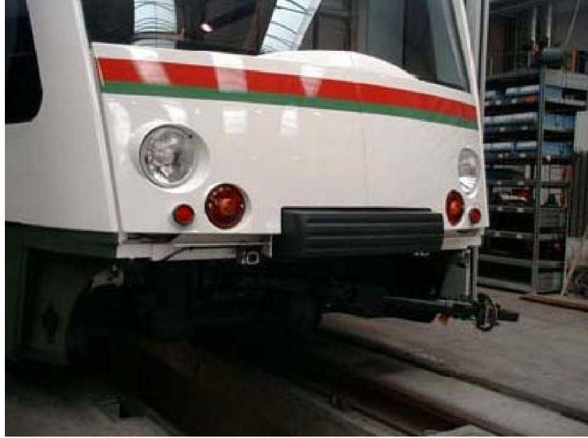
Şekil 2.17 Alüminyum köpüğün trende enerji absorbesi için kullanılması (Stöbener vd., 2003)
