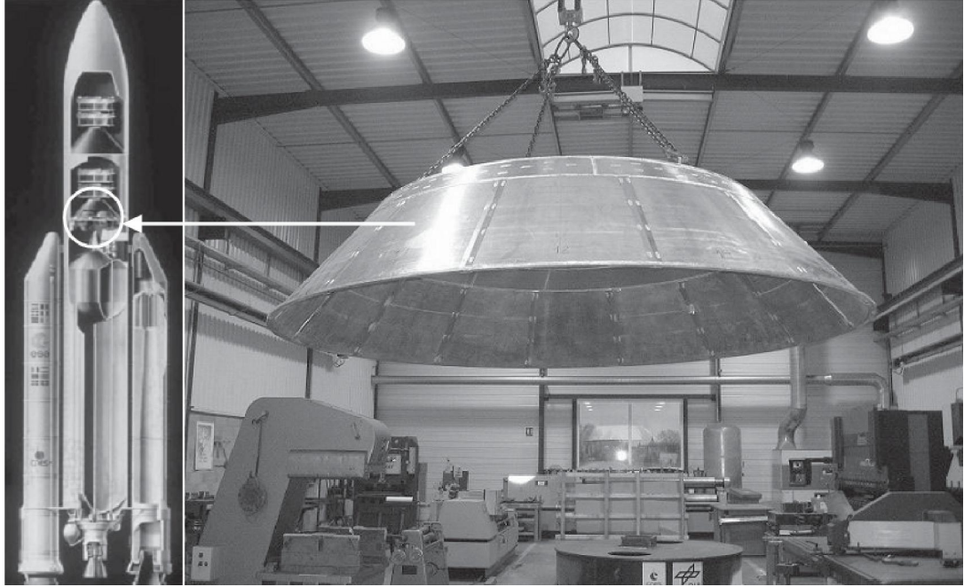
Şekil 2.18 Ariane 5 roketinde kullanılan alüminyum köpük koni adaptör
