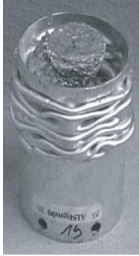
Şekil 2.16 Çarpışma kutusu örneği (Degischer vd., 2002)
