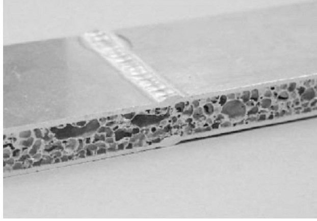
Şekil 3.4 TIG kaynağı (Degischer vd., 2002)
