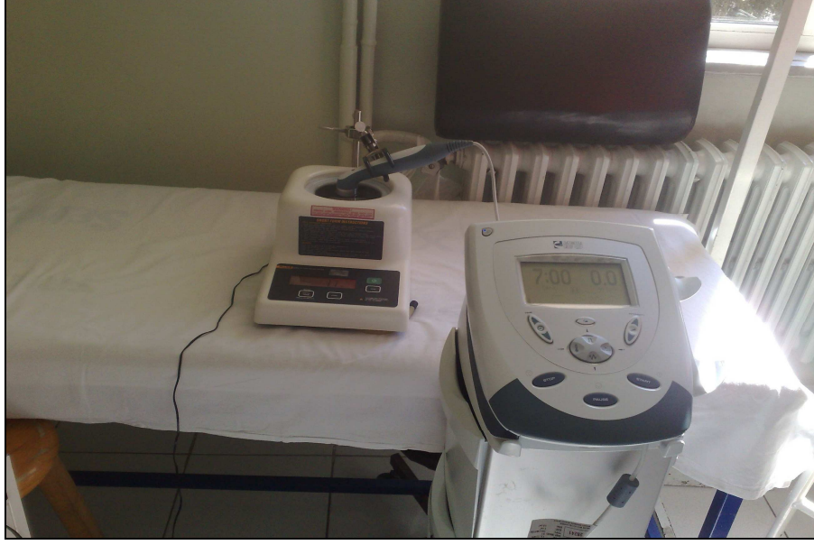
Şekil 3.2: Ultrason cihazında güç ölçümü.
