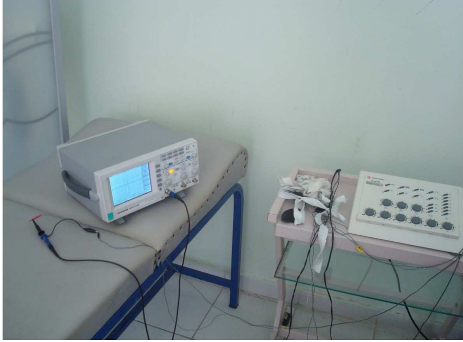
Şekil 3.8: Elektroterapi cihazı kalibrasyon ölçümü.
