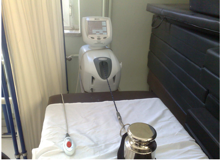
Şekil 3.9: Traksiyon cihazı kalibrasyon ölçümü.
