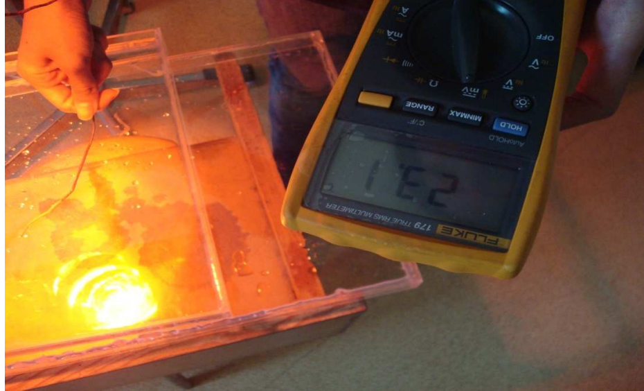
Şekil 3.10: Kızılötesi (İnfraruj) lamba kalibrasyon ölçümü.
