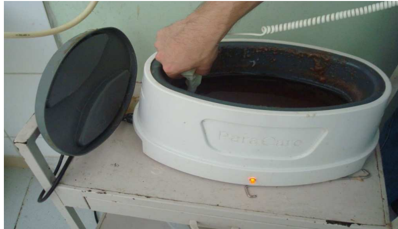
Şekil 3.12: Parafin cihazı kalibrasyon ölçümü.
