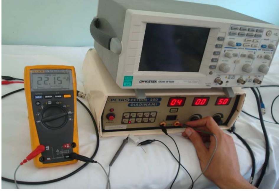
Şekil 3.7: Diadinami cihazı akım ölçümü.
