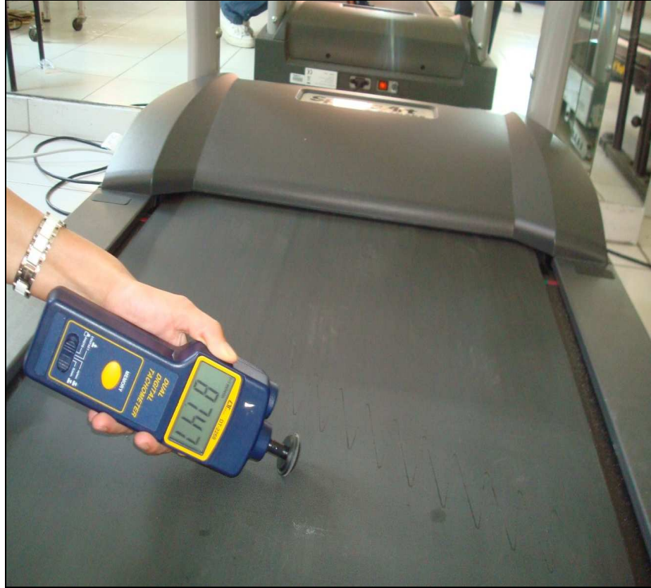
Şekil 3.11: Koşu bandı (Treadmill) hız ölçümü.
