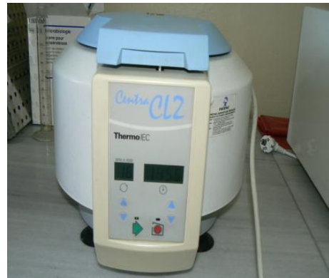
Şekil 3. 23: Tükürük karışımını debrislere ayırmak için kullanılan santrifüj cihazı
