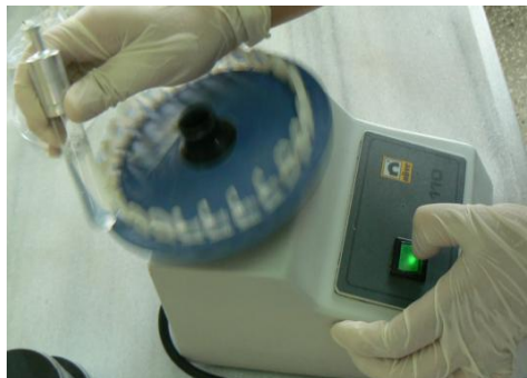
Şekil 3. 30: Bakteri süspansiyonunun vorteks cihazında karıştırılması
