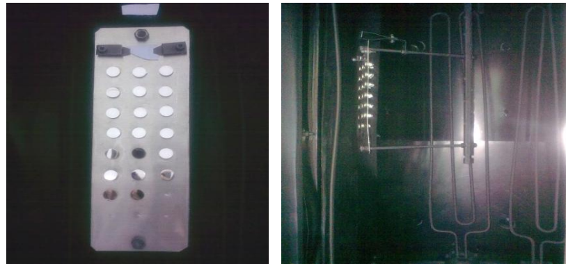
Şekil 3. 13: Kaplama işlemi öncesi deney örneklerinin sac levha üzerine sabitlenmesi (Sol) ve levhanın vakum odası içerisindeki yerleşimi (Sağ)
