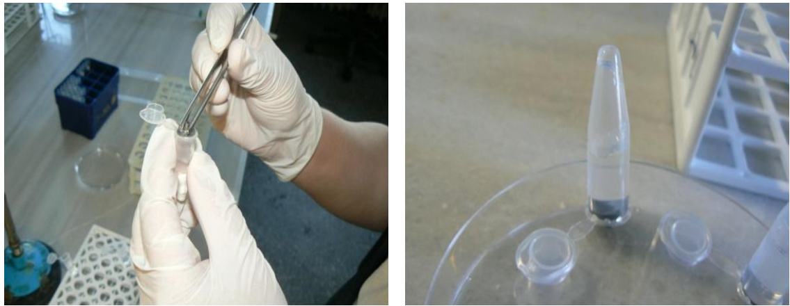
Şekil 3. 32: Deney örneğinin tükürük içeren ependorf tüpüne sıkıştırılması
