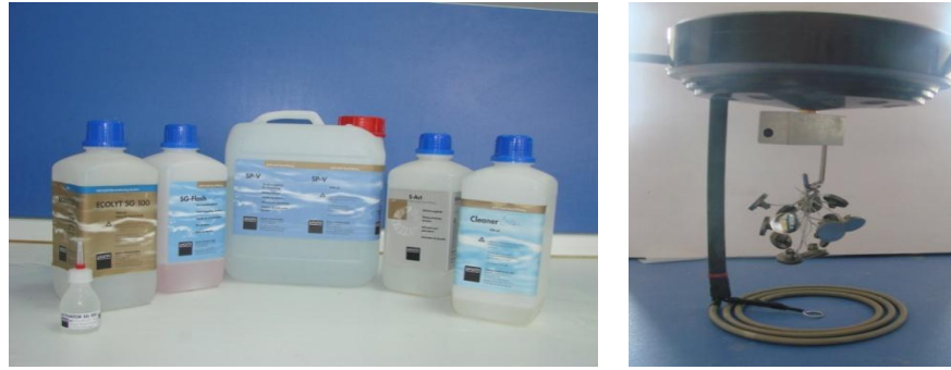
Şekil 3. 9: Altın kaplama işleminde kullanılan solüsyonlar (sol) ve kaplama başlığı ünitesine asılan deney örnekleri (sağ)
