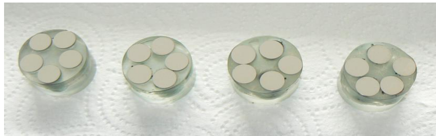
Şekil 3. 5: Parlatma işlemi tamamlanmış epoksi rezin kalıba gömülü örnekler
