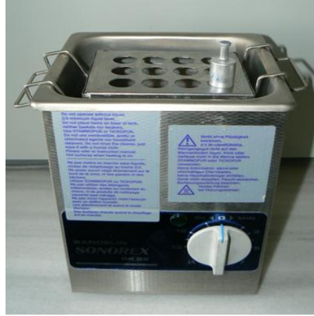
Şekil 3. 38: Ultrasonik titreşim cihazı ve deney tüpünün yerleşimi
