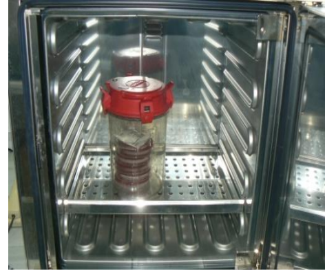
Şekil 3. 36: Bakteriyel adezyonun temini için petrilerin etüve kaldırılması
