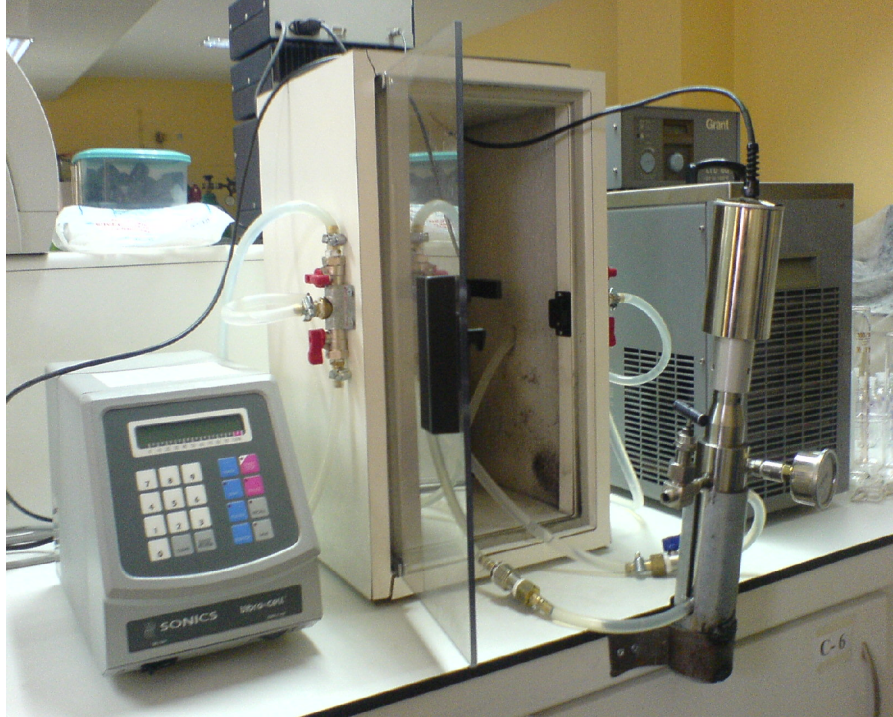
Şekil 3.4 : Sesötesi işlemci sistemi: Sesötesi işlemci (solda), Reaktörün, içerisine yerleştirildiği ses yalıtım kabini ve önünde reaktör (ortada), Sıcaklık kontrol edici (sağda)
