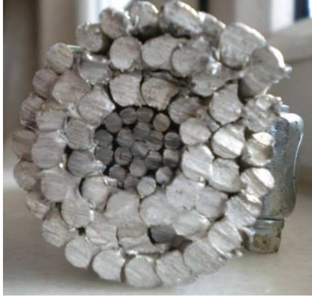
Şekil 3.4. Denizli – Afyon arasında 380kV gerilim taşıyan kablonun yapısı
