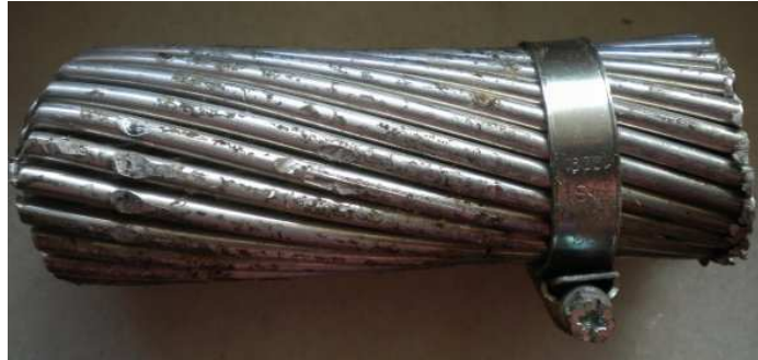
Şekil 3.3. Denizli – Afyon arasında 380kV gerilim taşıyan kablo örneği
