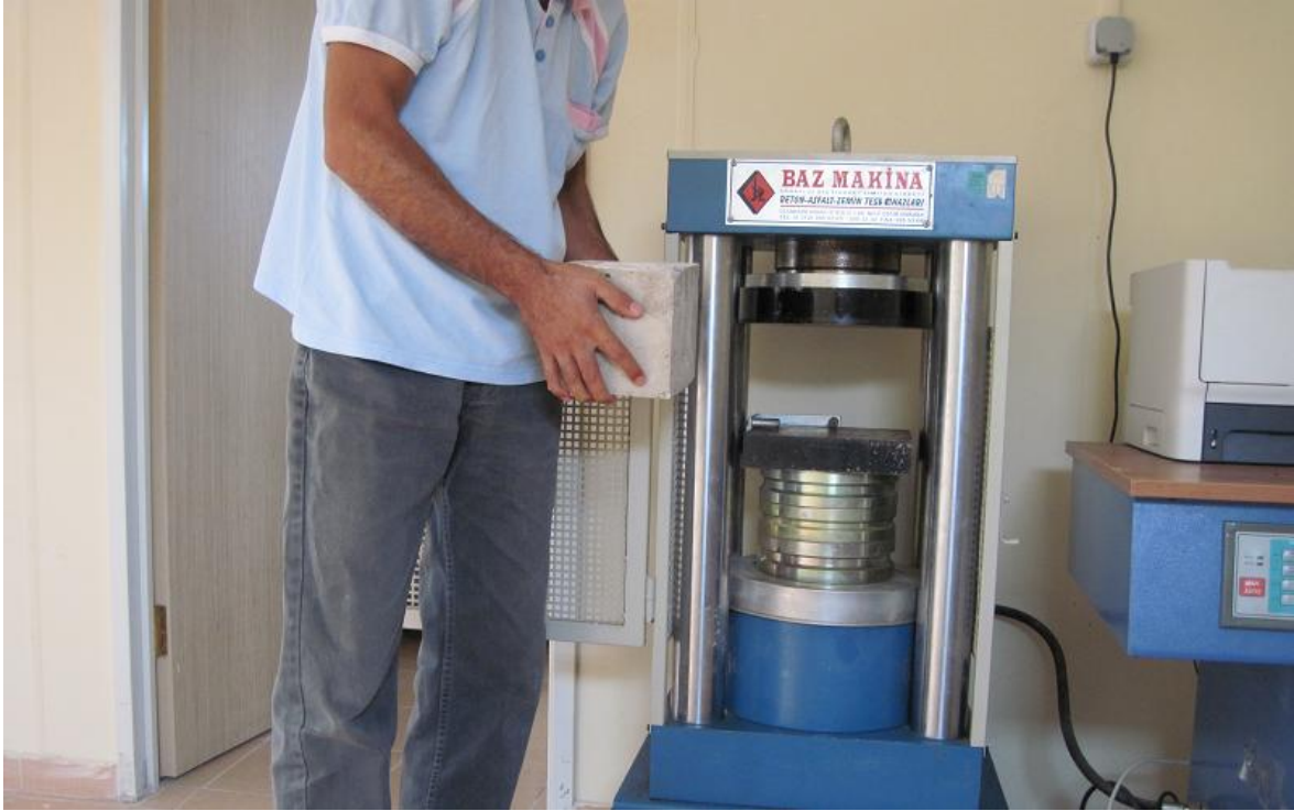
ŞEKİL 8: Beton basınç deneyinin gerçekleştirildiği kırma cihazı
