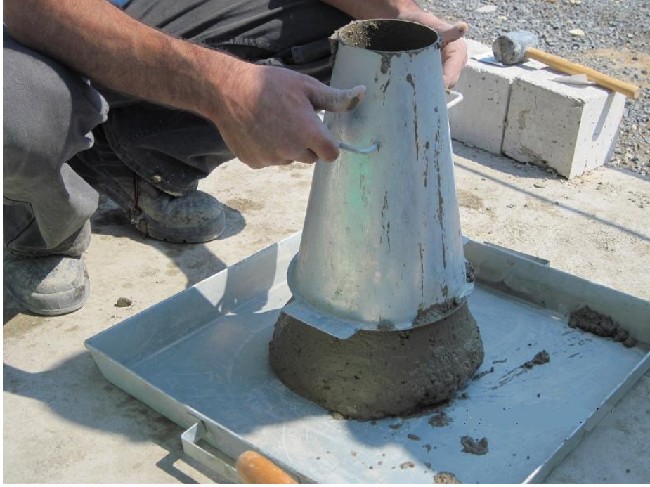
ŞEKİL 15: Çökme deneyinde çökme miktarının ölçülmesi
