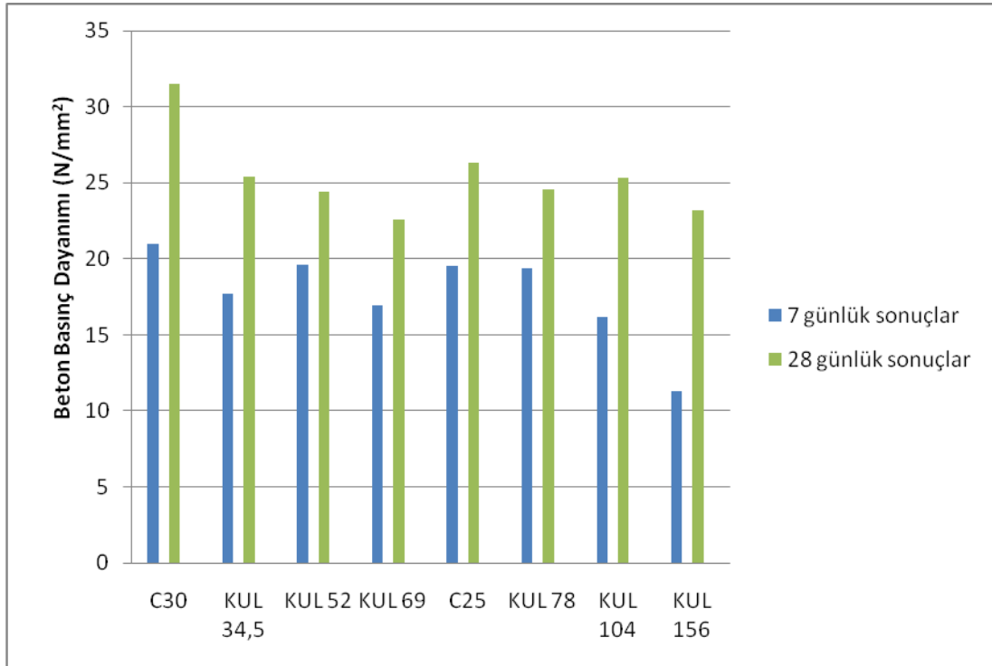
ŞEKİL 18: Tüm numunelerin 7 ve 28 günlük basınç dayanım test sonuçları
