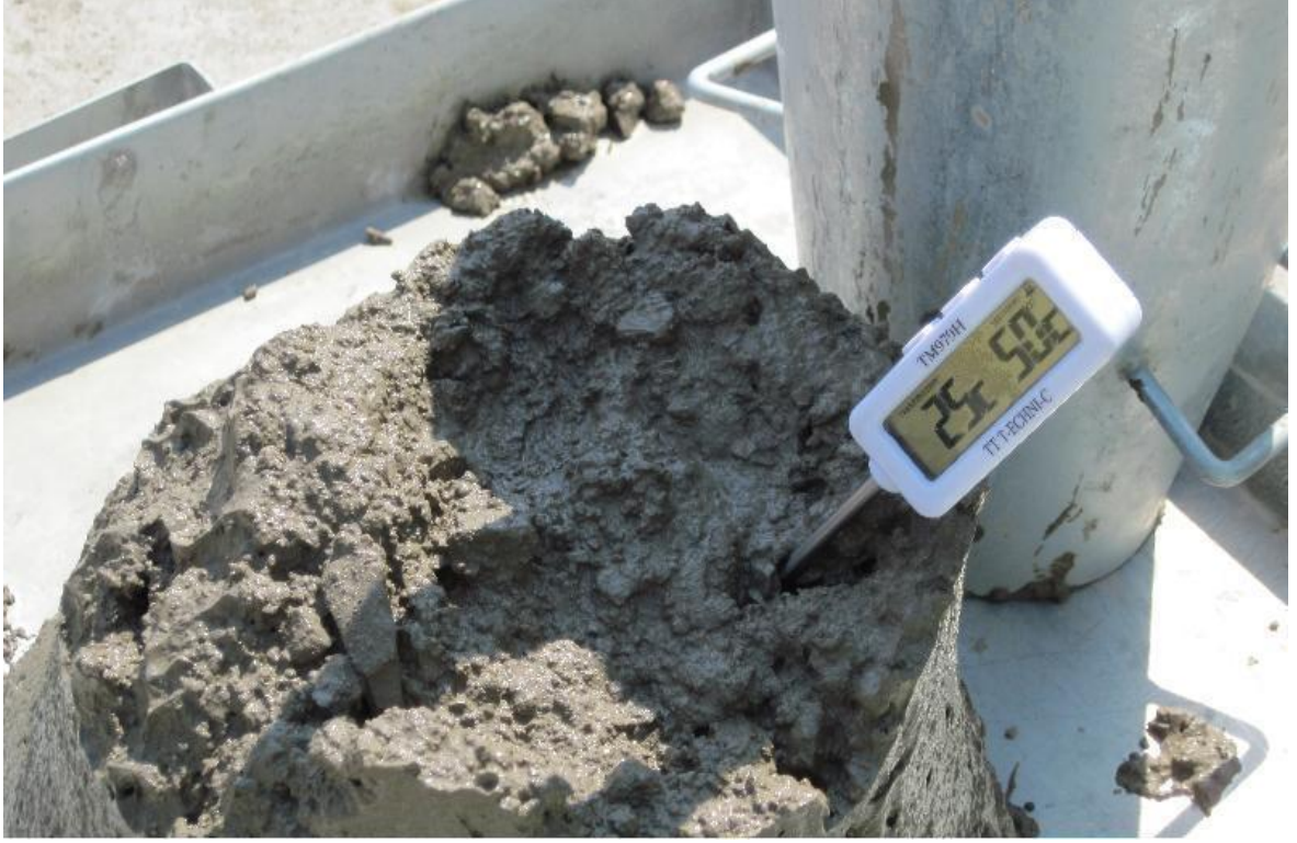
ŞEKİL 13: Taze beton numunelerinin sıcaklığının ölçülmesi
