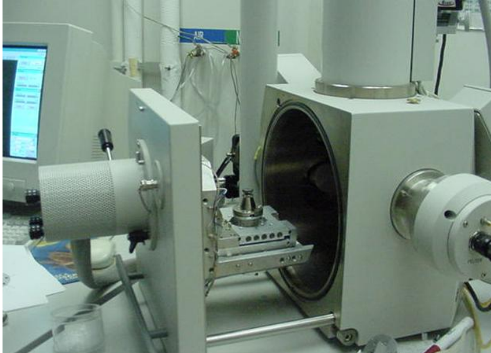
ŞEKİL 9: Taramalı elektron mikroskobu (Çelik, 2009)
