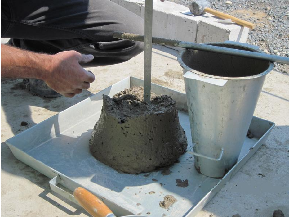
ŞEKİL 15: Çökme deneyinde çökme miktarının ölçülmesi
