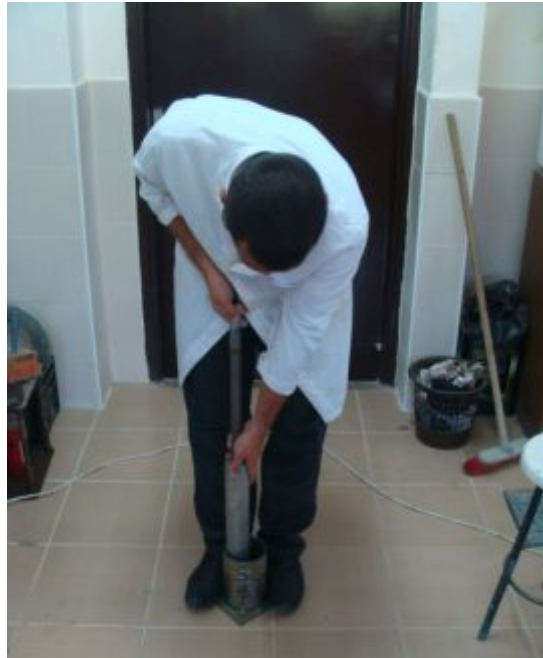
Şekil 3.10. Standart proctor deneyiyle numunenin sıkıştırılması
