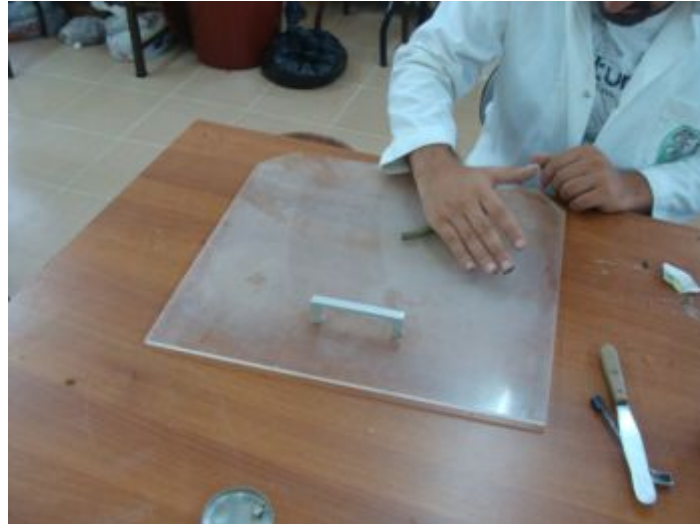
Şekil 3.3. Plastik limit deneyinin yapılışı
