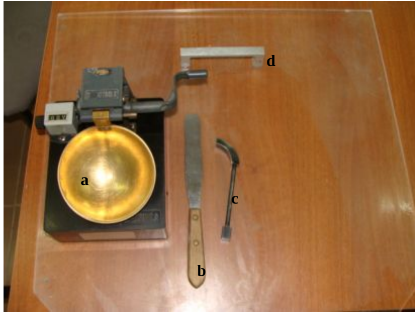
Şekil 3.1 Atterberg limitleri deney seti a) Casagrande deney aleti b)Flexible c)Oyuk açma bıçağı d) Cam levha
