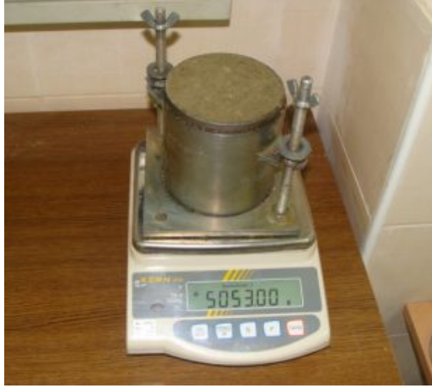
Şekil 3.11 Üst yüzeyi traşlanan numunenin tartılması
