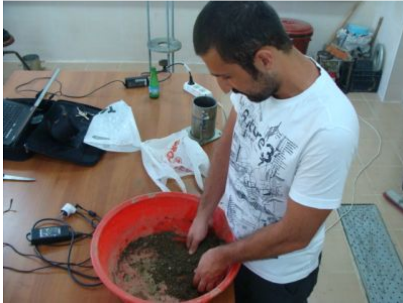
Şekil 3.9 Kompaksiyon numunesinin hazırlanışı
