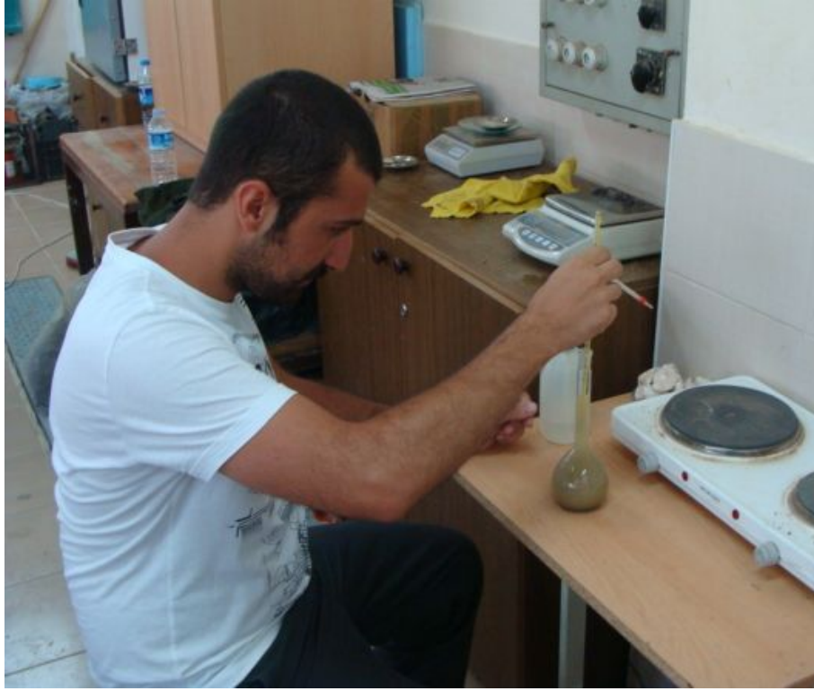
Şekil 3.4. Piknometre içerisindeki karışımın sıcaklığının ölçülmesi
