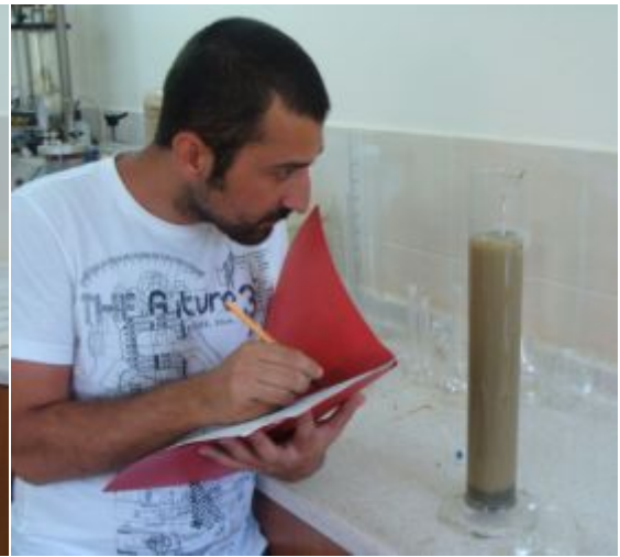
Şekil 3.6. Mezürün baş aşağı getirilmesi Şekil 3.7. Hidrometre okumasının alınışı
