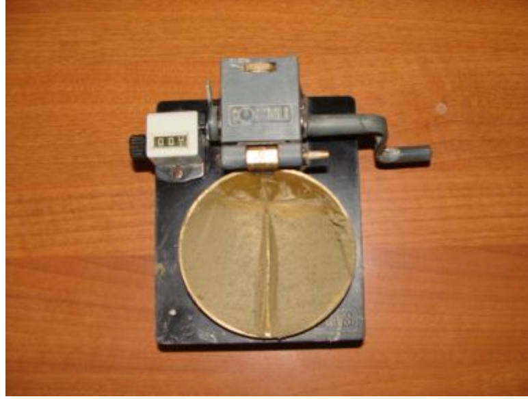
Şekil 3.2. Likit limit cihazında 13 mm'lik kapanmanın görüldüğü an
