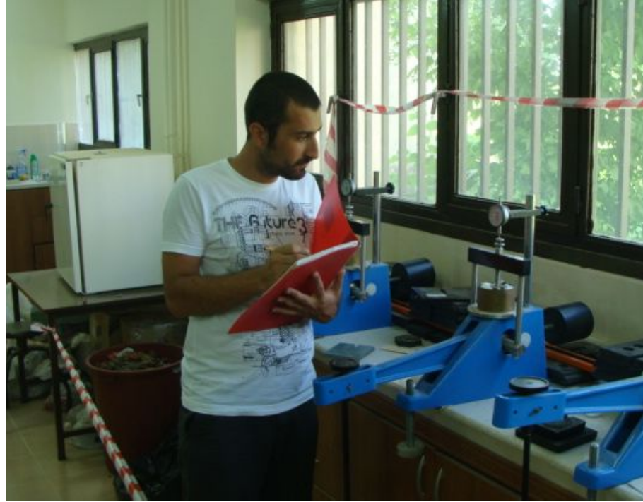
Şekil 3.18 Konsolidasyon deney okumasının alınışı
