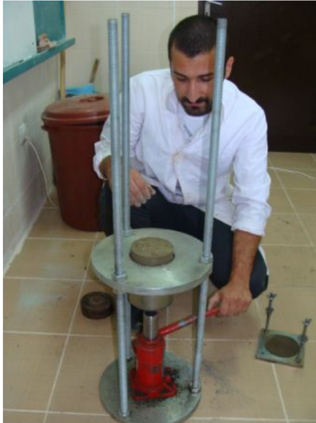
Şekil 3.12 Numunenin kriko yardımıyla molddan çıkarılışı
