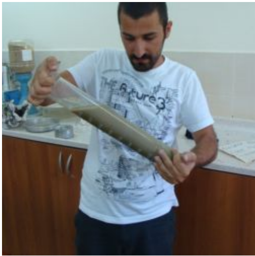
Şekil 3.6. Mezürün baş aşağı getirilmesi Şekil 3.7. Hidrometre okumasının alınışı
