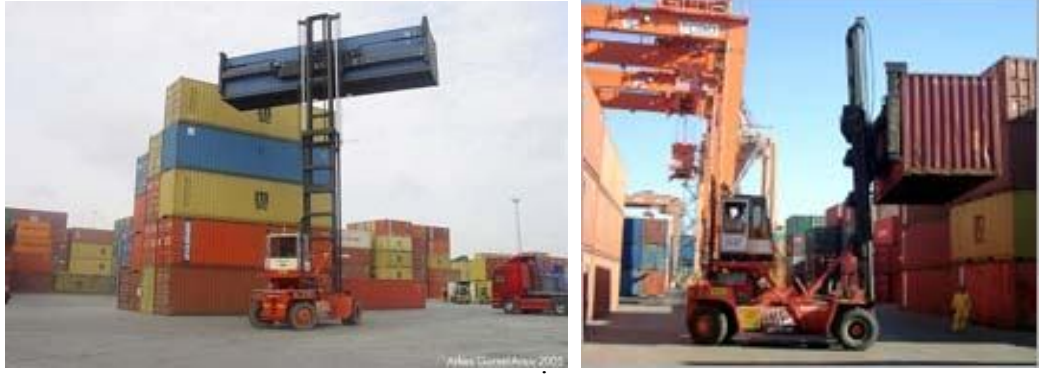
Şekil 3.11 Boş Konteyner İstifleyicisi (ECS) [16]
