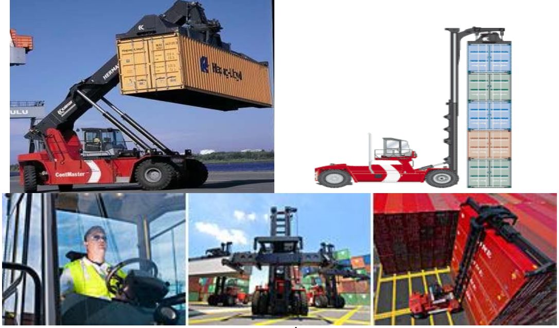
Şekil 3.10 Dolu Konteyner İstifleyicisi (CRS) [16]
