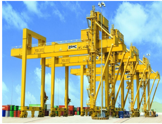
Şekil 3.6 Raylı Gantry Kreyni [6]
