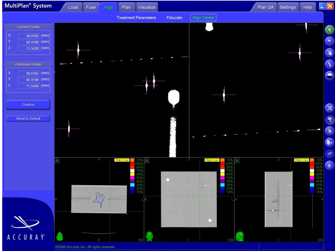
Şekil 3.22 Film ölçümleri için hizalama merkezinin belirlenmesi görüntüsü
