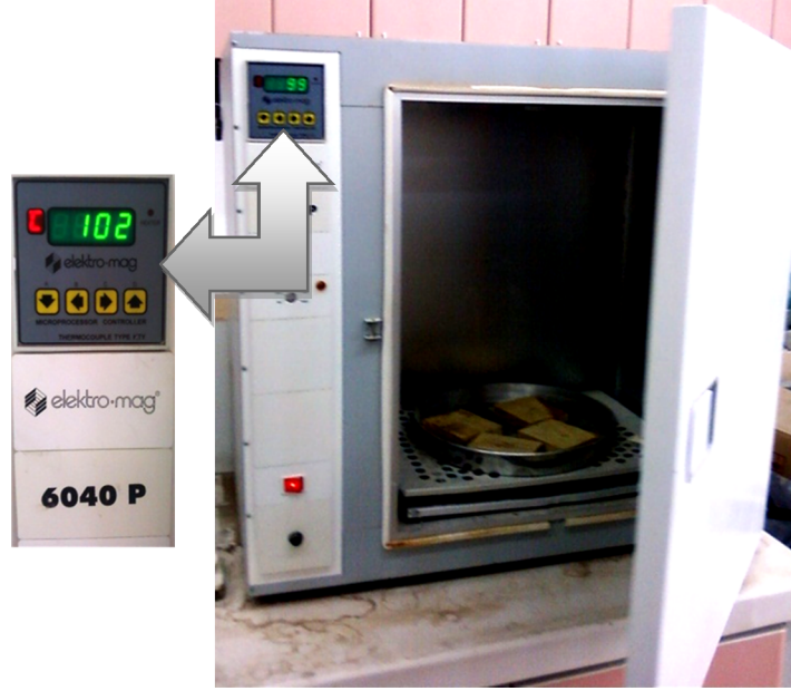
Şekil 3.13. Kereste numunelerinin etüv fırınında kurutulması
