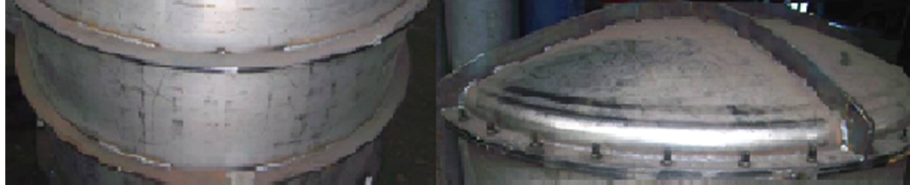
Şekil 3.2. Kurutma fırınının imalat aşamasındaki tank dışı ve kapak görüntüsü
