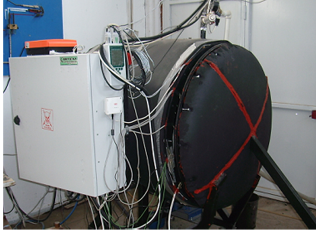
Şekil 3.3. PLC destekli kurutma fırını
