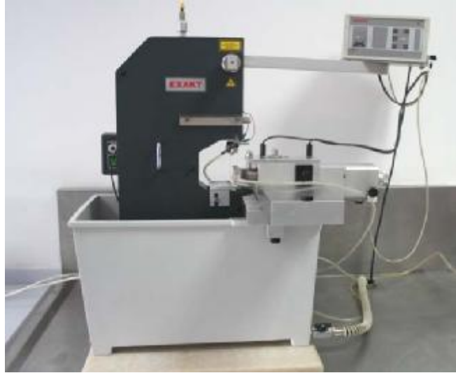
Şekil 3.7. Exakt 300 CP Hassas Kesme Ünitesi
