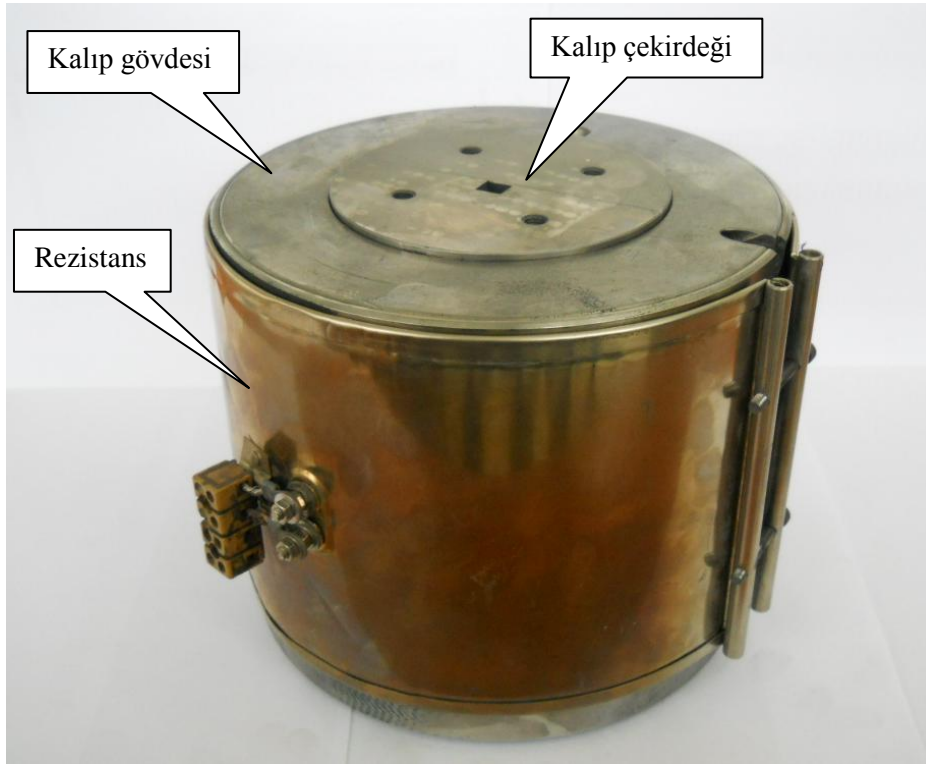
Şekil 5. Kalıp gövdesi ve etrafına sarılan sac şeklinde rezistansın görünümü
