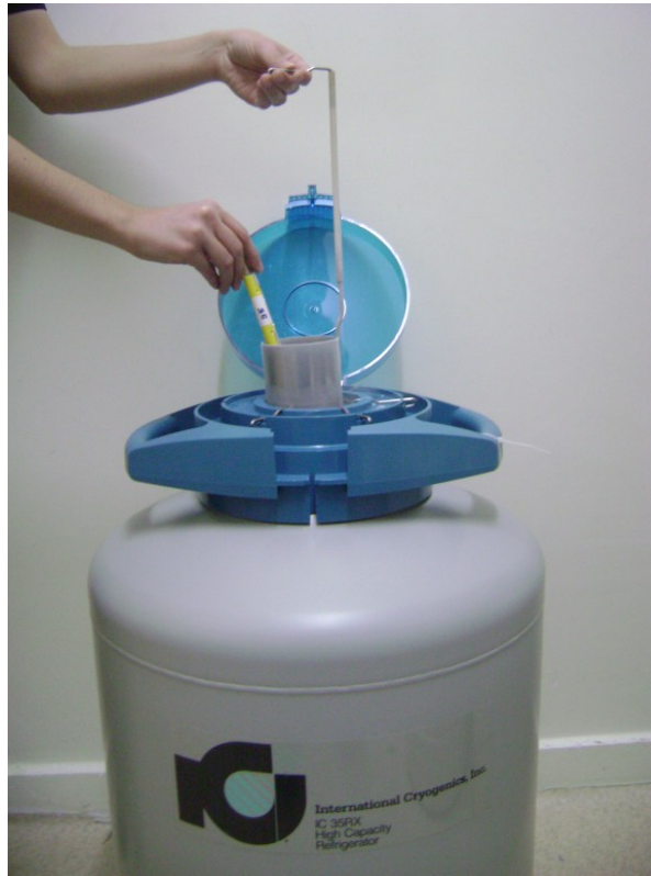
Resim 2.13. İçerisinde Oosit Yüklü Fibreplug'ların Bulunduğu Gobletin, Saklanacağı Sıvı Azot Tankına Bırakılması.
