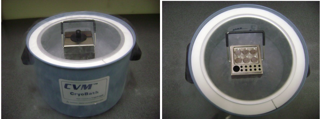
Resim 2.3. Kriyo Küvet İçerisinde Soğutulan Kriyoblok.
