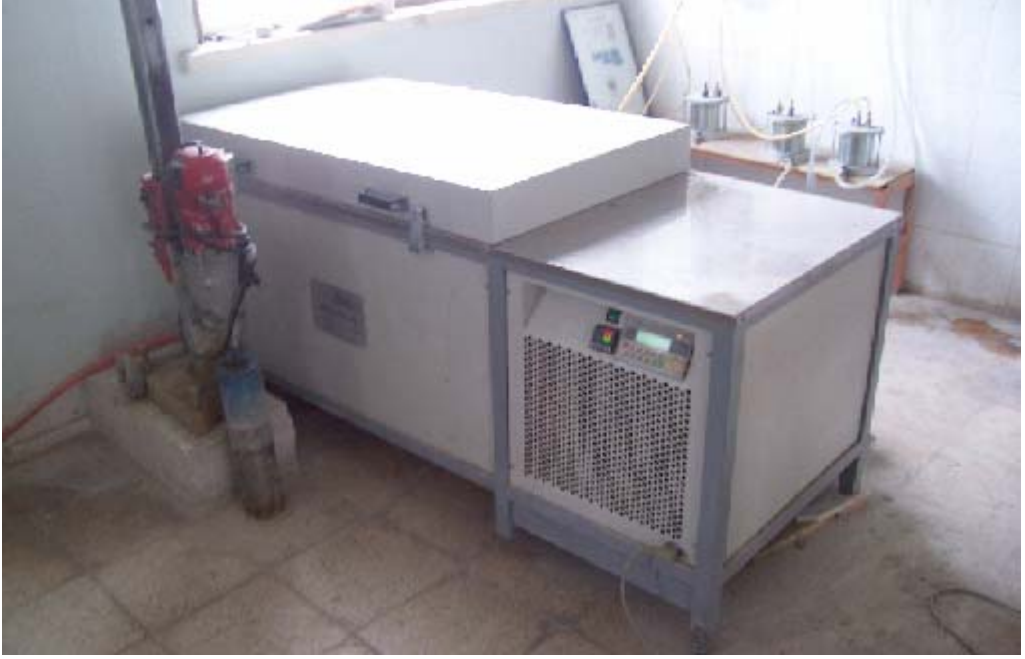
Şekil 7.7. Dona dayanım deneylerinin yapıldığı dondurma – çözme dolabı
