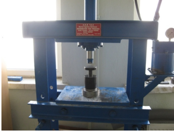
Şekil 7.5. Şekillendirme işleminde kullanılan hidrolik pres ve kalıp.
