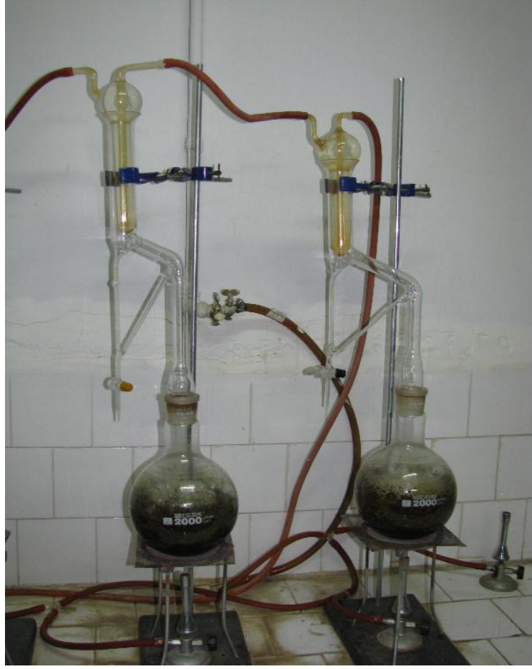
Şekil 3.15 Clevenger cihazı ile uçucu yağ elde edilmesi
