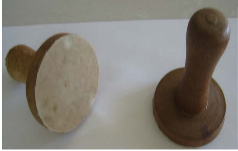
Şekil 3.2 Replika Plate yönteminde kullanılan damga
