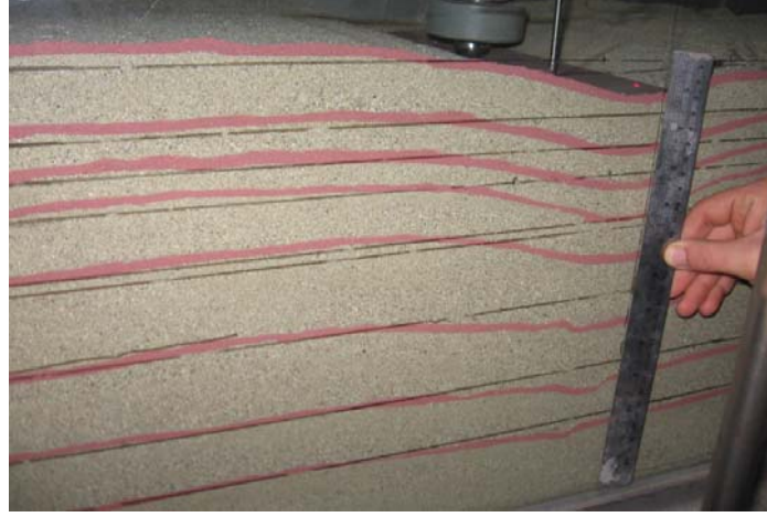
Şekil 4.220. Oturma profili ( L/B=3 ; u/B=0,35 ; h/B=0,4 ; N=2 )
