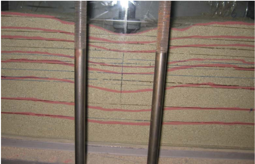
Şekil 4.50. Donatılı deney sonucunda meydana gelen göçme davranışı ( u/B=0,35 ; h/B=0,6 ; L/B=3 , N=2 )
