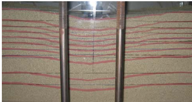
Şekil 4.271. Altı donatılı sistemde temel yükleme sonucu oluşan oturma profili ( L/B=3 ; u/B=0,35 ; h/B=0,2 ; N=6 )
