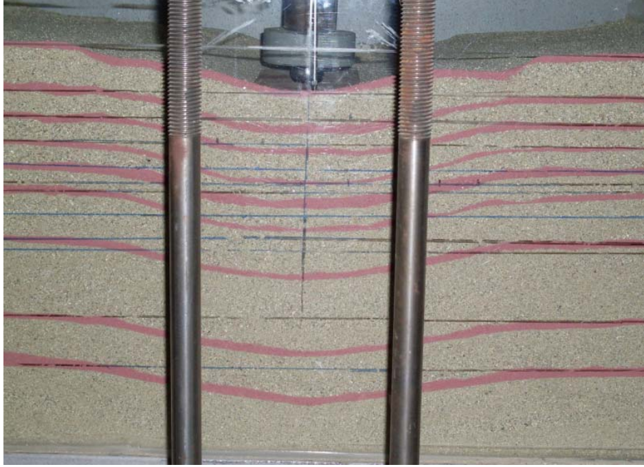
Şekil 4.27. Farklı donatı aralıklarında yapılan deneylerde oluşan göçme davranışı ( N=4 ; h/B=0,6 ; u/B=0,35 ; L/B=3 )
