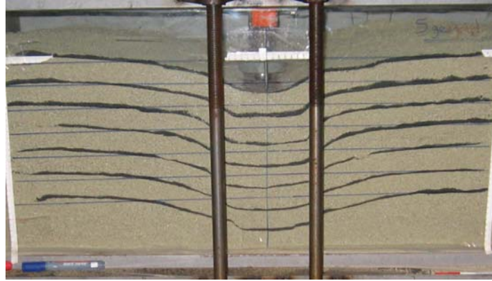
Şekil 4.171. Geogrid 3 kullanılarak donatılan orta sıkı kumlu deneyin oturma profili ( u/B=0,35 ; L/B=3 ; h=0,4B ; N=5 )
