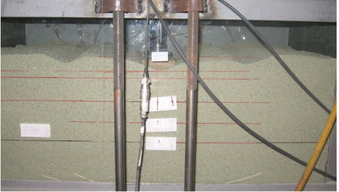
Şekil 4.45. Donatılı deney sonucunda meydana gelen göçme davranışı ( u/B=0,35 ; L/B=5 , N=1 )
