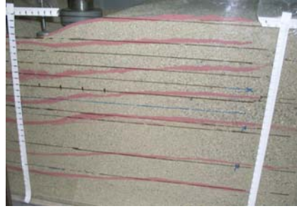
Şekil 4.305. Oturma profili ( L/B=3 ; u/B=0,55 ; h/B=0,4 ; N=3 )
