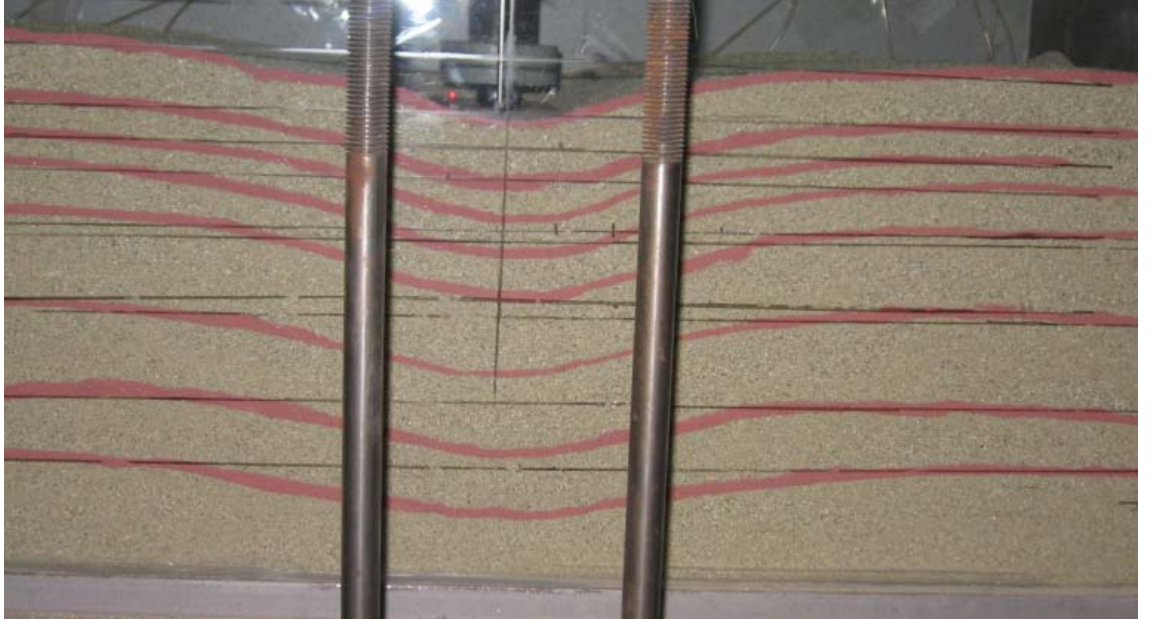
Şekil 4.42. Donatılı deney sonucunda meydana gelen göçme davranışı ( u/B=0,35 ; h/B=0,4 ; L/B=3 , N=4 )
