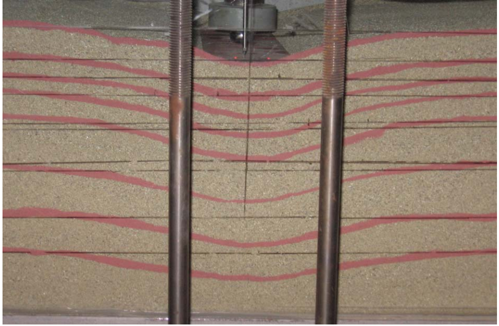
Şekil 4.26. Farklı donatı aralıklarında yapılan deneylerde oluşan göçme yüzeyleri ( N=4 ; h/B=0,4 ; u/B=0,35 ; L/B=3 )
