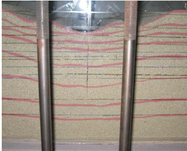
Şekil 4.246. İki donatılı sistemde temel yüklemesi sonucu oluşan oturma profili ( L/B=3 ; u/B=0,35 ; h/B=0,2 ; N=2 )
