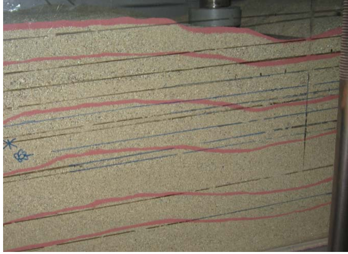
Şekil 4.202. Oturma profili ( L/B=3 ; u/B=0,35 ; h/B=0,6 ; N=3 )
