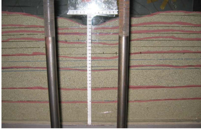
Şekil 4.128. Donatılı deney sonucunda meydana gelen oturma profili ( u/B=0,35 ; L/B=3 ; h/B=0,4 ; N=1 )
