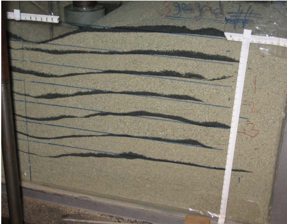
Şekil 4.114. Donatılı deney sonucunda meydana gelen oturma profili ( u/B=0,75 ; L/B=5 ; h/B=0,4 ; N=3 )
