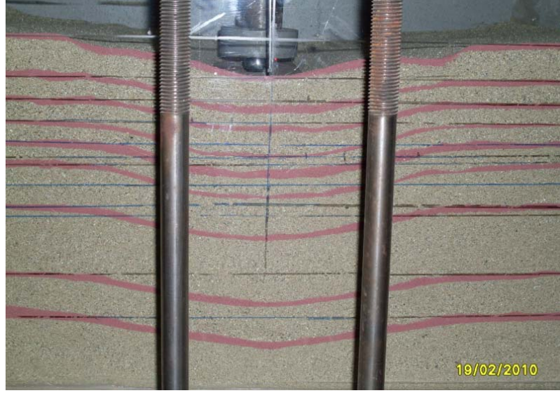
Şekil 4.51. Donatılı deney sonucunda meydana gelen göçme davranışı ( u/B=0,35 ; h/B=0,6 ; L/B=3 , N=4 )
