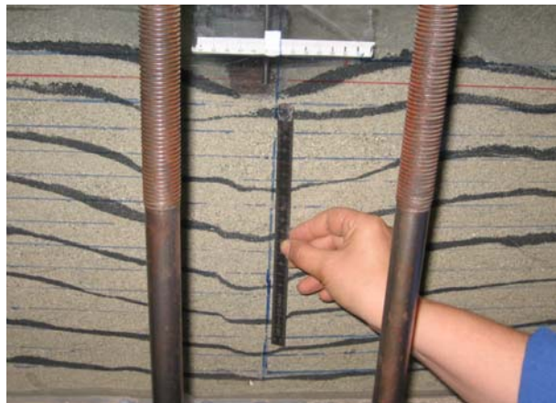
Şekil 4.85. Donatılı deney sonucunda meydana gelen oturma profili ( u/B=0,35 ; L/B=5 ; h/B=0,4 ; N=3 )
