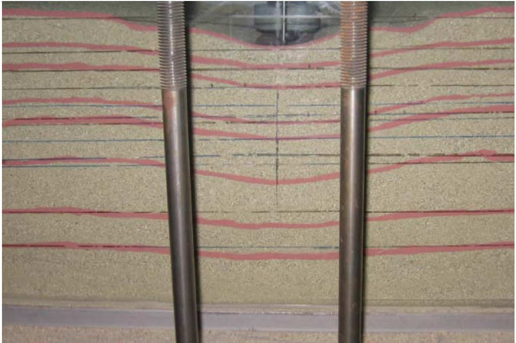
Şekil 4.28. Farklı donatı aralıklarında yapılan deneylerde oluşan göçme davranışı ( N=2 ; h/B=0,6 ; u/B=0,35 ; L/B=3 )
