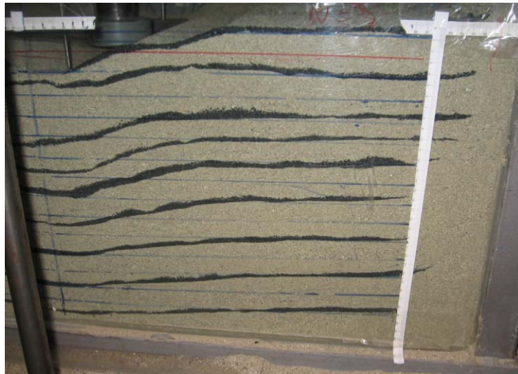
Şekil 4.119. Donatılı deney sonucunda meydana gelen oturma profili ( u/B=0,35 ; L/B=3 ; h/B=0,6 ; N=3 )
