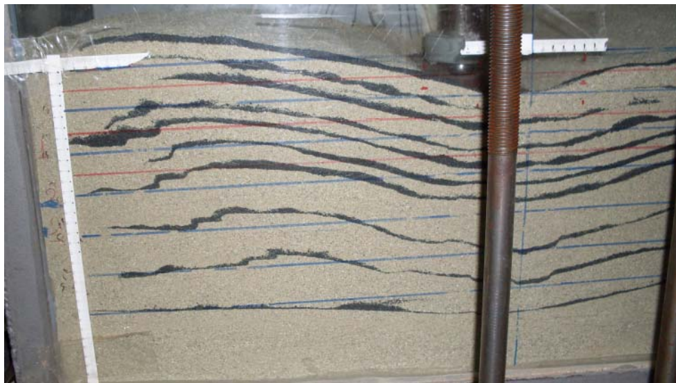
Şekil 4.65. Donatılı deney sonucunda meydana gelen göçme davranışı ( u/B=0,175 ; L/B=3 , h/B=0,4 ; N=3 )
