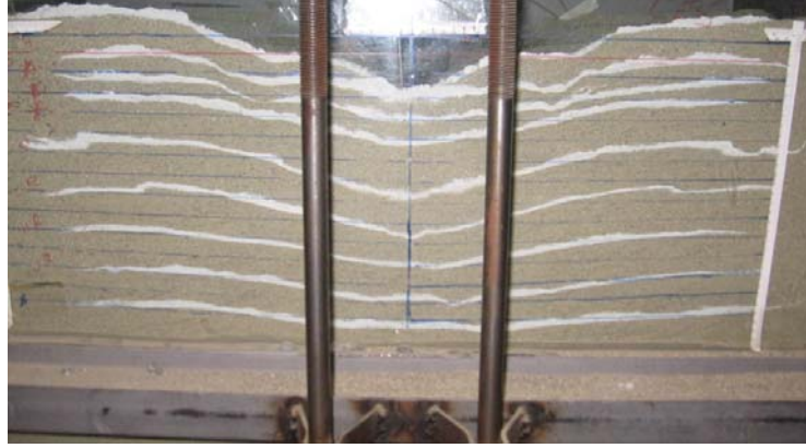
Şekil 4.98. Donatılı deney sonucunda meydana gelen oturma profili ( u/B=0,35 ; L/B=3 ; h/B=0,2 ; N=3 )
