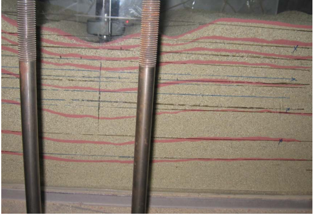
Şekil 4.54. Donatılı deney sonucunda meydana gelen göçme davranışı ( u/B=0,35 ; h/B=0,2 ; L/B=3 , N=2 )
