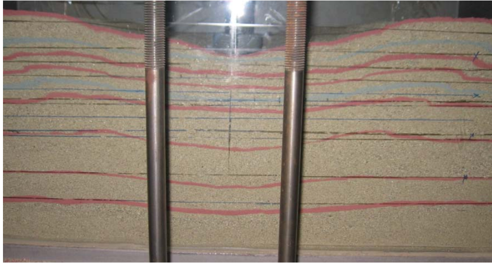
Şekil 4.14. N=2 donatılı kumda yapılan deney sonucu oluşan oturma profili ( u/B=0,55 ; L/B=3 ; h/B=0,4 ; N=2 )
