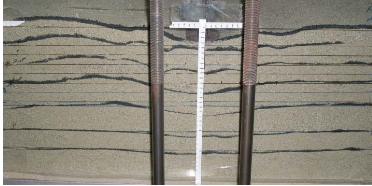
Şekil 4.134. Donatılı deney sonucunda meydana gelen oturma profili ( u/B=0,35 ; L/B=3 ; h/B=0,4 ; N=2 )
