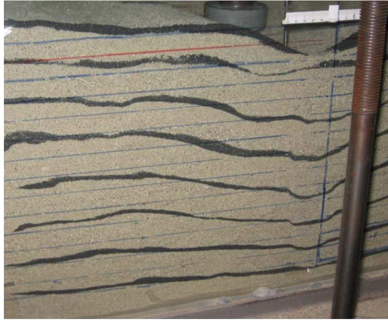
Şekil 4.107. Donatılı deneyin oturma profili ( u/B=0,35 ; L/B=5 ; h/B=0,4 ; N=3 )
