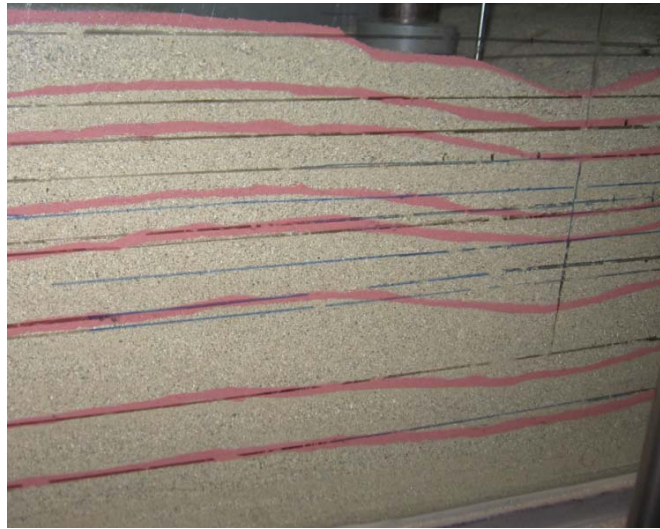
Şekil 4.193. İki donatılı sistemde temel yüklemesi sonucu oluşan oturma profili ( L/B=3 ; u/B=0,35 ; h/B=0,6 ; N=2 )
