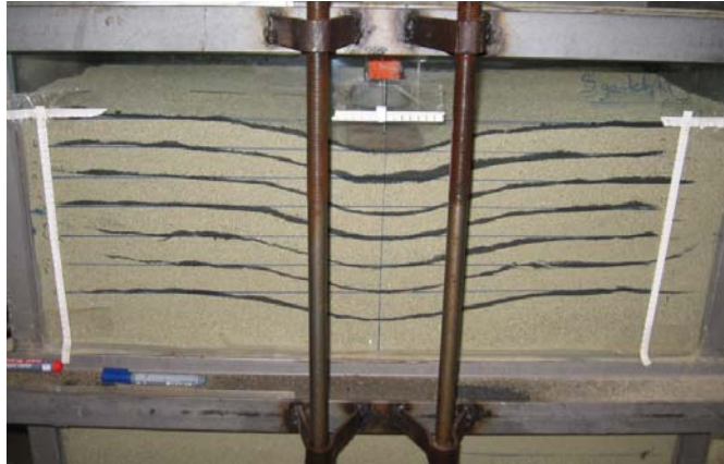
Şekil 4.169. Geotekstil kullanılarak donatılan orta sıkı kumlu deneyin oturma profili ( u/B=0,35 ; L/B=3 ; h=0,4B ; N=5 )
