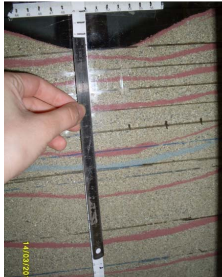
Şekil 4.296. Oturma profili ( L/B=3 ; u/B=0,55 ; h/B=0,4 ; N=2 )
