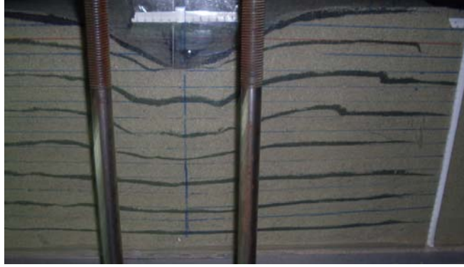
Şekil 4.78. Donatılı deney sonucunda meydana gelen göçme davranışı ( u/B=0,35 ; L/B=1 ; N=1 )
