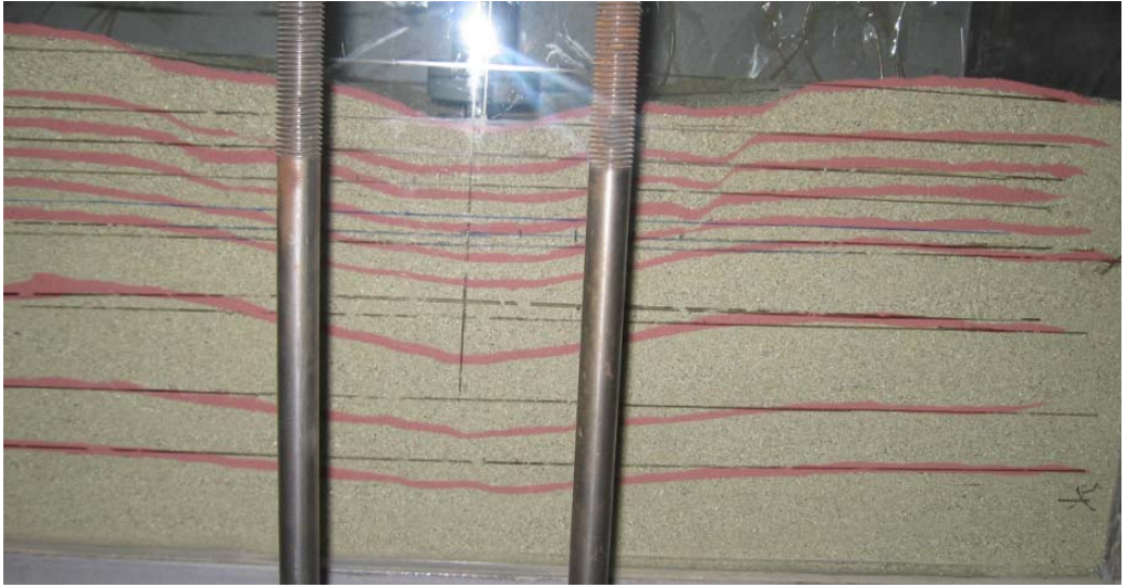
Şekil 4.55. Donatılı deney sonucunda meydana gelen göçme davranışı ( u/B=0,35 ; h/B=0,2 ; L/B=3 , N=4 )
