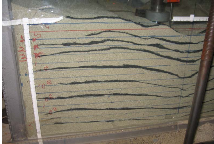
Şekil 4.117. Donatılı deney sonucunda meydana gelen oturma profili ( u/B=0,35 ; L/B=3 ; h/B=0,2 ; N=3 )
