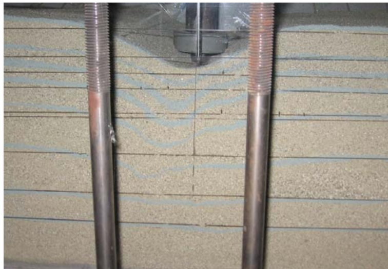
Şekil 4.3. Donatısız deney sonucu zeminde meydana gelen göçme şekli
