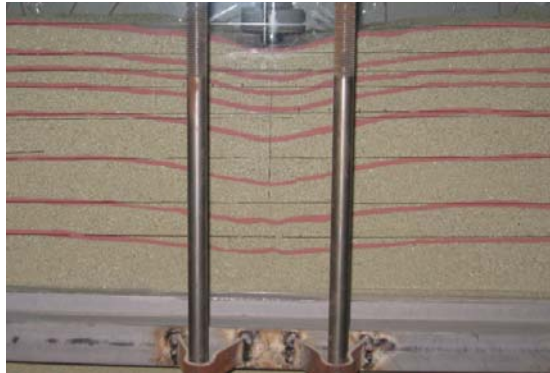
Şekil 4.228. Üç donatılı sistemde temel yüklemesi sonucu oluşan oturma profili ( L/B=3 ; u/B=0,35 ; h/B=0,4 ; N=3 )
