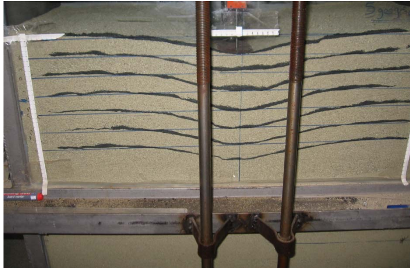
Şekil 4.129. Donatılı deney sonucunda meydana gelen oturma profili ( u/B=0,35 ; L/B=3 ; h/B=0,4 ; N=5 )
