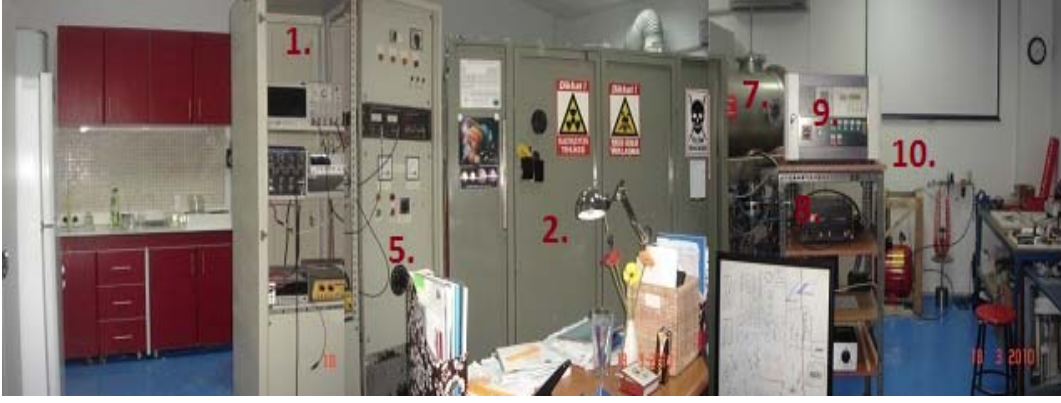
Şekil 3.4 Ege Üniversitesi Yüzey Modifikasyon Laboratuvarı'nın genel görüntüsü (1. Elektrik - elektronik donanım kontrol paneli, 2. Yüksek gerilim odası, 3. Mevva iyon üretici, 4. Ark ve tetikleyici güç kaynağı, 5. a. Ark akımı kontrolü 5. b. İyon hızlandırıcı kontrolü, 6. İzolasyon trafosu, 7. Yüksek gerilim güç kaynağı ( 110 kVd.c ), 8. Yüksek gerilim, 9. Vakum sistemi)
