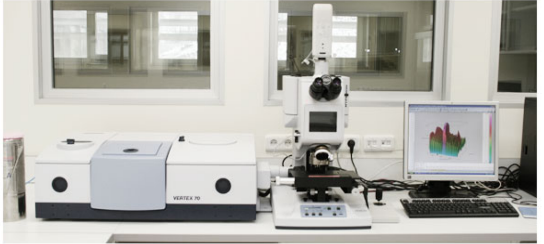
Şekil 4.5 ATR/FTIR ölçümlerinin gerçekleştirildiği Bilkent Üniversitesi - Ulusal Nanoteknoloji Merkezi (UNAM)'a ait Bruker marka, VERTEX 70 with Hyperion Scanning Microscope model Smart DuraSamplIR 3 Bounce diamond HATR (3 reflection diamond ATR) mod FT/IR
