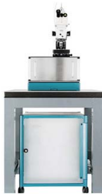
Şekil 4.6 Raman ölçümlerinin gerçekleştiği Bilkent Üniversitesi - Ulusal Nanoteknoloji Merkezi (UNAM)’da bulunan 632 nm. dalga boylu ( \lambda = 632 nm.) He-Ne lazer kullanan, Witec Alpha 300S Konfokal Raman Mikroskop
