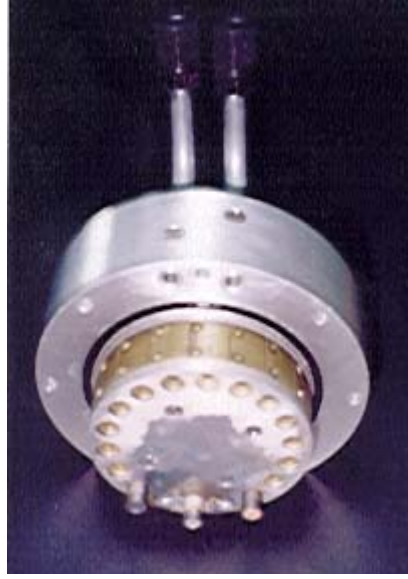
Şekil 3.6 Katot tutucu (18 ayrı katot, dönebilen ve su soğutmalı, prinçten yapılmış )
