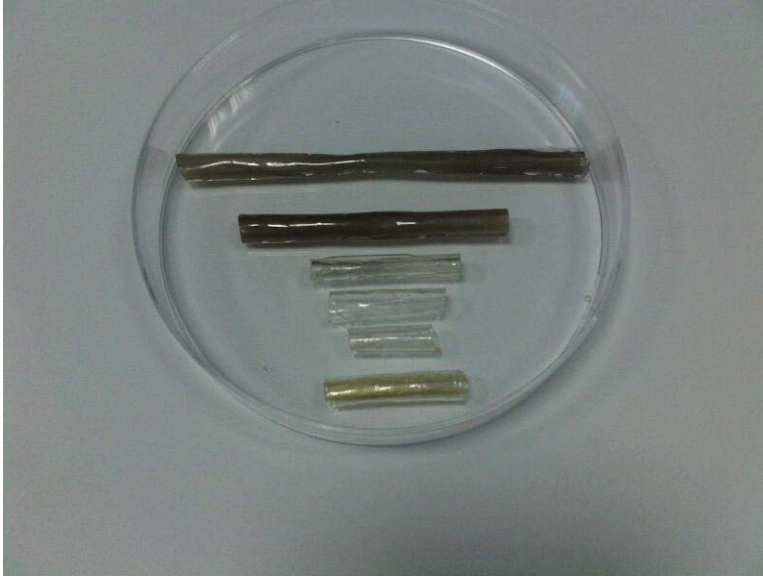
Şekil 6.2 Tez kapsamında hazırlanan, iyon ışını ile yüzeyleri modifiye edilmiş, elmasa benzer karbon film kaplı biyobozunur polimer tüp'ler
