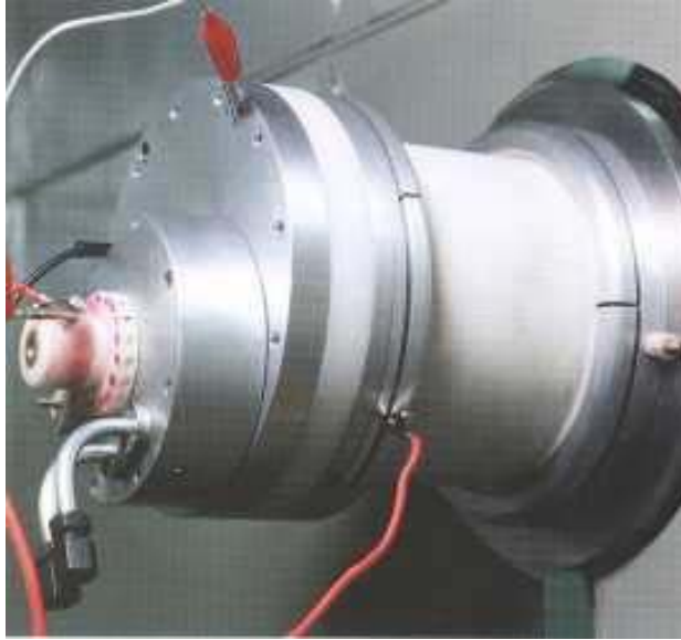
Şekil 3.5 Metal buharlı vakum ark iyon üretici.
