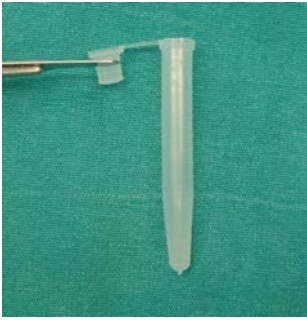
Resim 5.4.: Mikrosantrifüj tüpünün kapağının bistüri ile 2 mm boyunda kesilmesi ve kesilen parçanın sond ile delinmesi.
