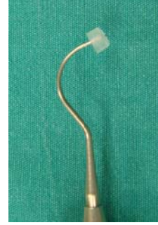
Resim 5.4.: Mikrosantrifüj tüpünün kapağının bistüri ile 2 mm boyunda kesilmesi ve kesilen parçanın sond ile delinmesi.
