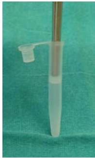
Resim 5.5.: Kesilen parçanın başka bir mikrosantrifüj tüpünün yarısına kadar gelecek şekilde itilmesi ve Periopaper ®'ın tüpün içine yerleştirilmesi.
