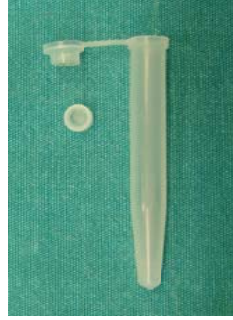
Resim 5.4.: Mikrosantrifüj tüpünün kapağının bistüri ile 2 mm boyunda kesilmesi ve kesilen parçanın sond ile delinmesi.
