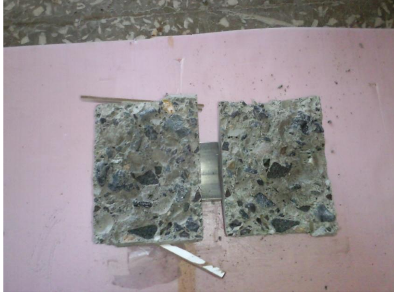
Şekil 2.8. Numunelerin kırılma şekilleri ve detayları
