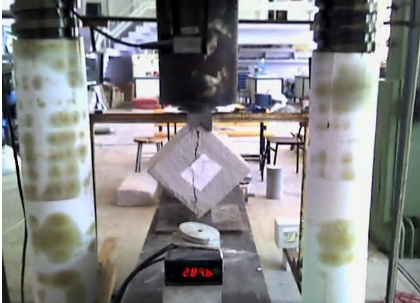
Şekil 2.5. Numunelerin kırılma şekilleri ve detayları ve değer okunması
