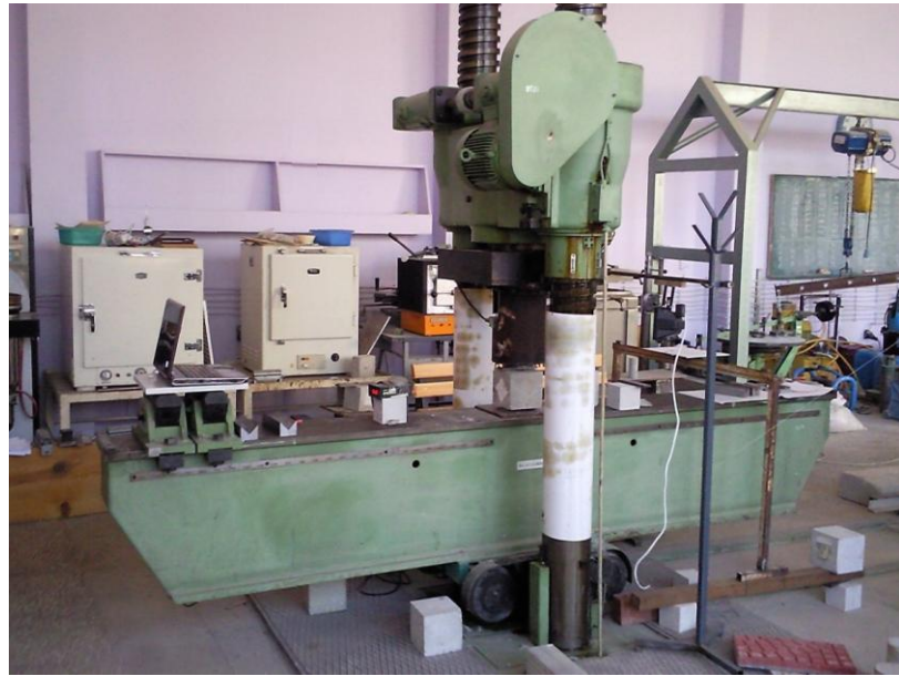
Şekil 2.3. Deneylerde kullanılan 2500kN kapasiteli hidrolik pres makinesi
