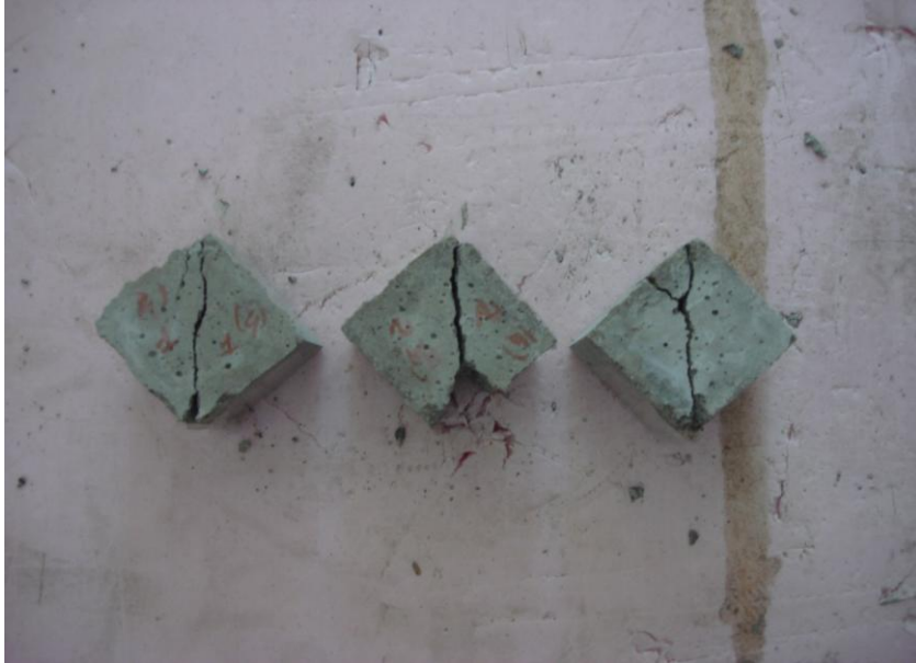
Şekil 2.11. Numunelerin kırılma şekilleri ve detayları
