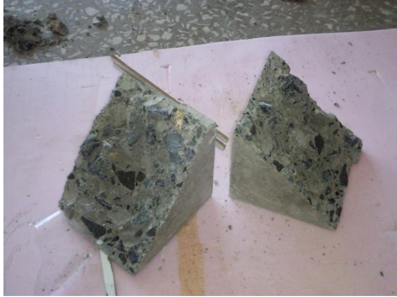
Şekil 2.9. Numunelerin kırılma şekilleri ve detayları
