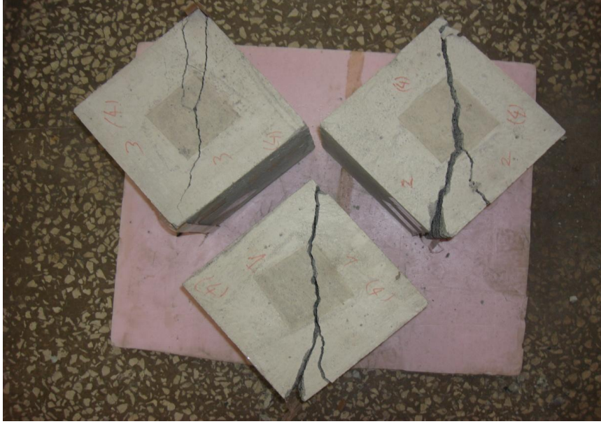
Şekil 2.14. Numunelerin kırılma şekilleri ve detayları
