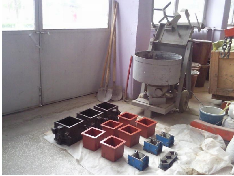
Şekil 2.2. Deneylerde kullanılan kalıplar ve mikser
