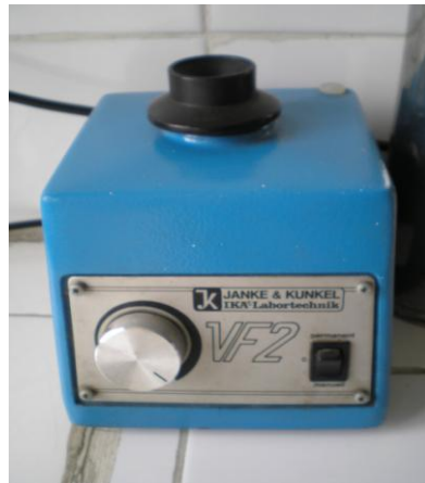
Şekil 3.9: Kullanılan vorteks (Janke &amp; Kunkel) ve etüv (Memmert).
