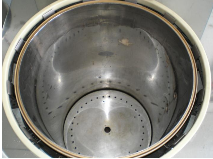
Şekil 3.2: Dik tip otoklavın iç hacmi (Hirayama Hiclave HV-85).
