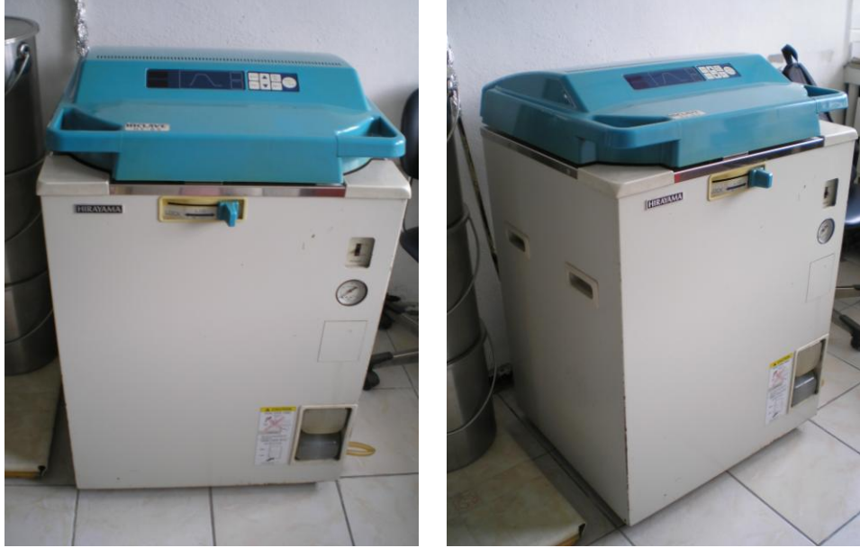
Şekil 3.1: Dik tip otoklav (Hirayama Hiclave HV-85).
