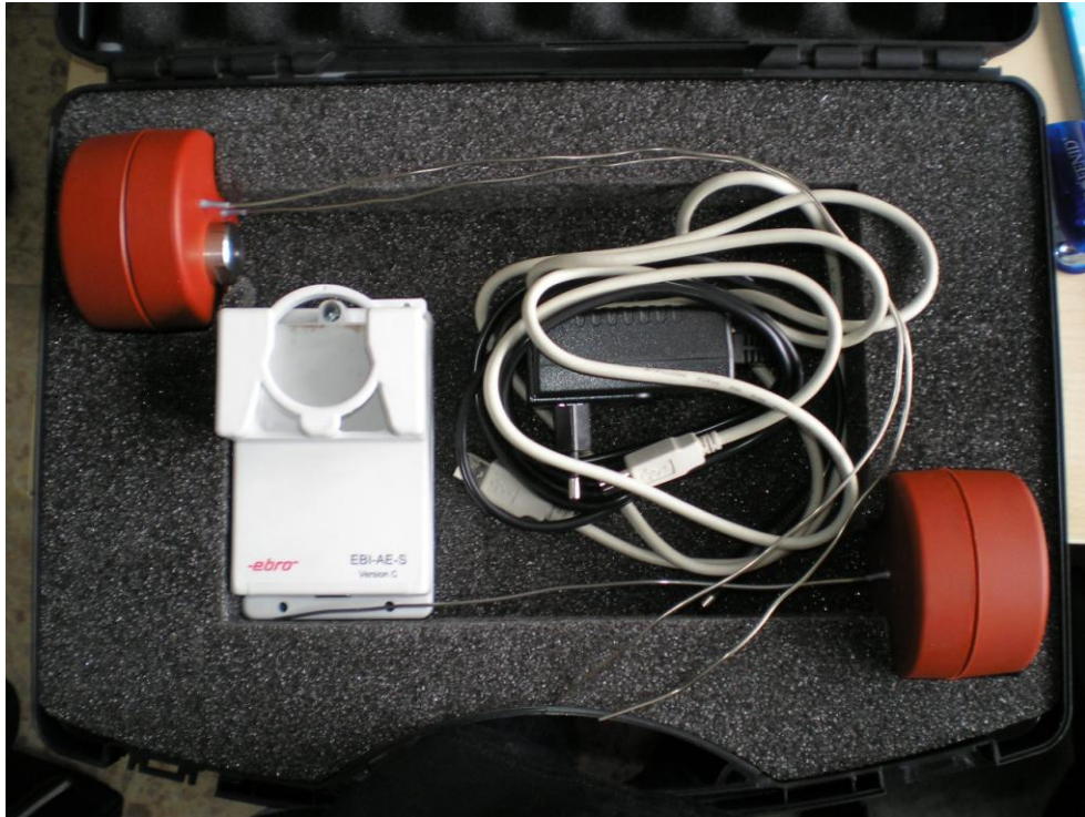
Şekil 3.5: Sıcaklık-basınç ölçüm cihazı ekipmanları (Ebro EBI AE-S-2000).
