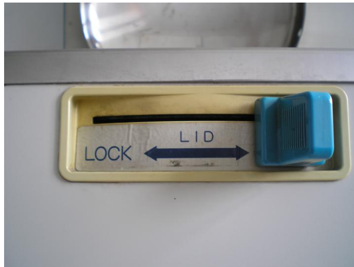
Şekil 3.3: Dik tip otoklavın kapak kilidi (Hirayama Hiclave HV-85).
