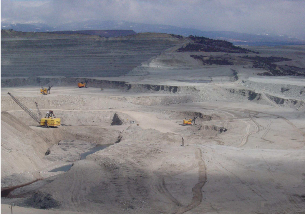
Şekil 3.5. Beke panosunda dragline uygulaması
