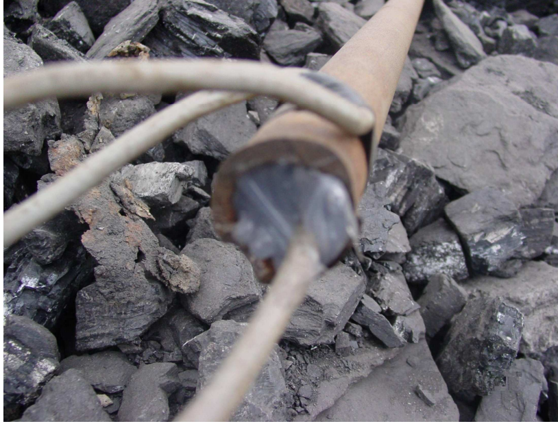
Şekil 4.11. Sondanın dışının silikonla kaplanması
