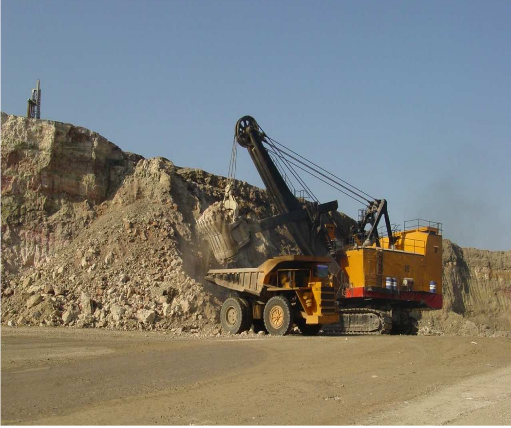
Şekil 3.3. Elektrikli ekskavatör-kamyon ile dekapaj çalışması
