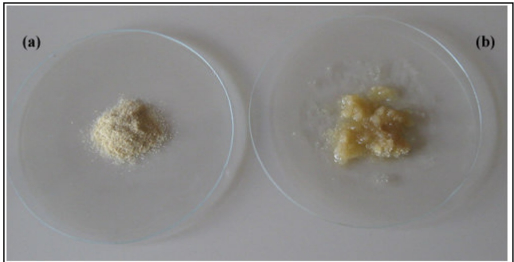
Şekil 3.3 : (a) Sodyum aljinat doğal polimeri, (b) sodyum aljinatın sıcak saf suda çözünmüş hali.
