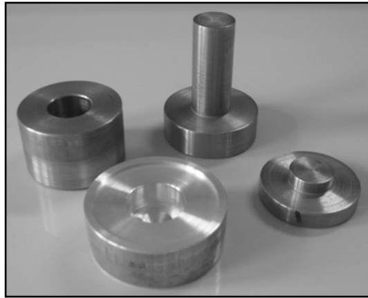
Şekil 3.6 : Alümina/BHA kompozit ve BHA tozlarını tablet formuna presleme aşamasında kullanılan paslanmaz çelik kalıplar.
