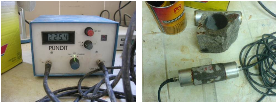
Şekil 4.21. Ultra ses cihazı ve ölçümü
