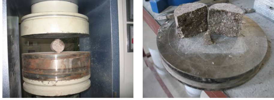
Şekil 4.20. Yarmada çekme testi ve kırılmış numune
