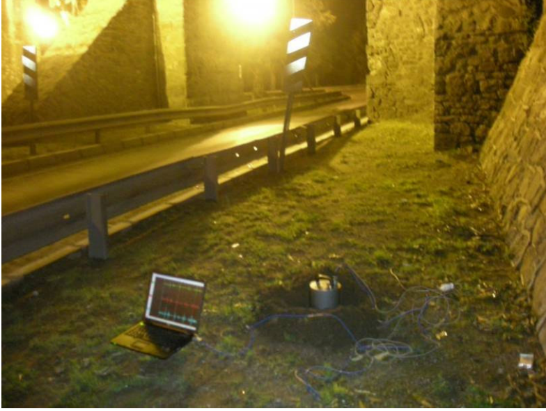
Şekil 5.58. Vezir Su Kemer i mikrotremor ölçümü
