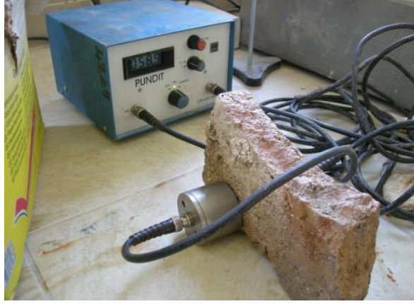
Şekil 5.32. Ultra ses darbe testi
