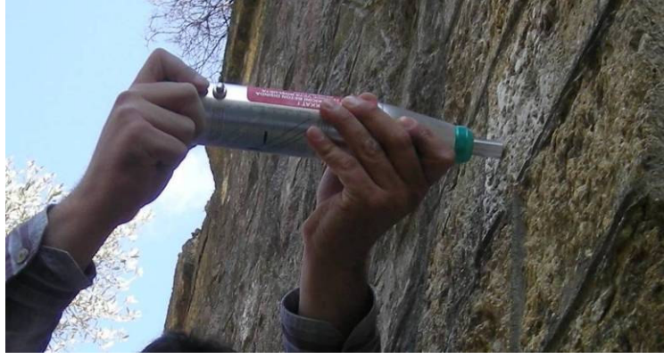
Şekil 4.17. Schmidt çekici testi (L tipi)
