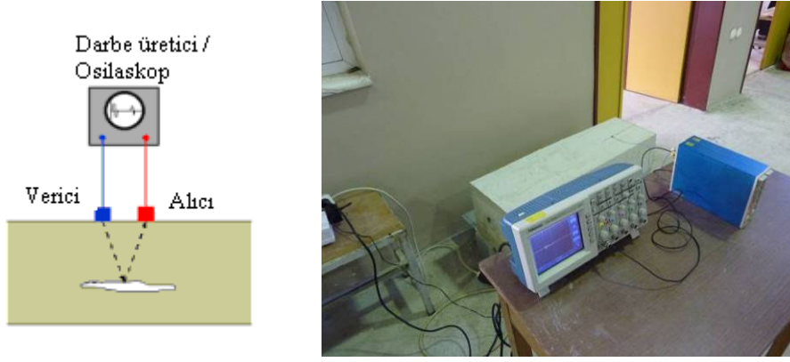
Şekil 4.14. Beton testinde kullanılan şematik bir puls-eko yöntemi
