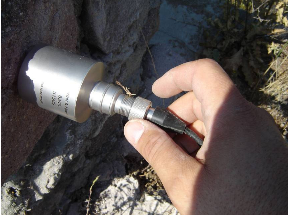
Şekil 5.66. 0-50 Hz aralığındaki titreşimlere duyarlı, 10 V/g hassasiyetinde ivmeölçer
