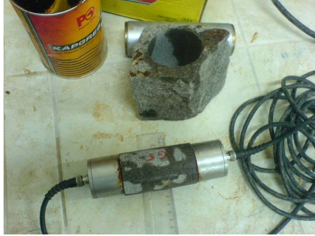
Şekil 5.17. Ultra ses darbe testi
