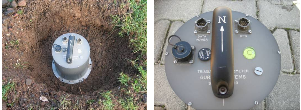
Şekil 5.60. CMG-5 tipi üç bileşenli dijital ivmeölçer cihazı
