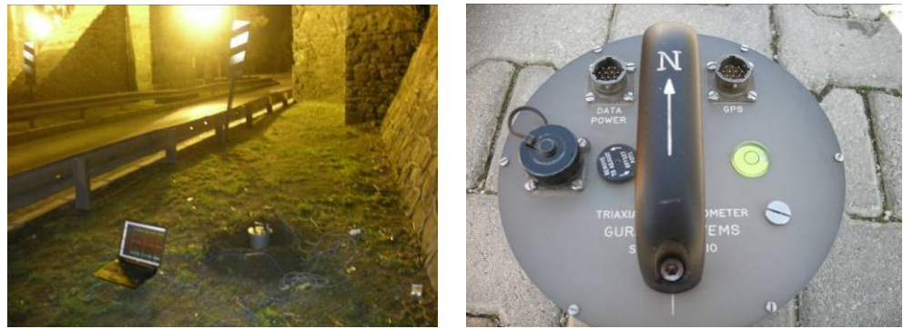
Şekil 4.23. Zemin hakim periyodunun tespiti ve 3 eksenli mikrotremor cihazı
