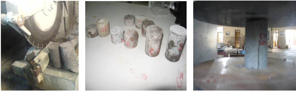
Şekil 4.19. Karot numunelerinin kesilmesi, hazırlanmış numuneler ve basınç testi
