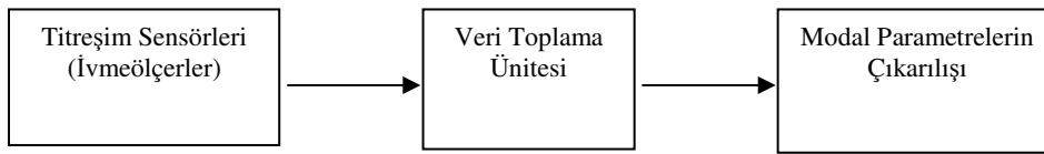
Şekil 4.11. Operasyonel Modal Analiz işlem sırası
