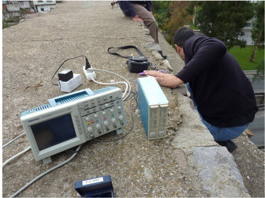
Şekil 5.85. Vezir Su Kemerı üzerinde darbe-eko testi
