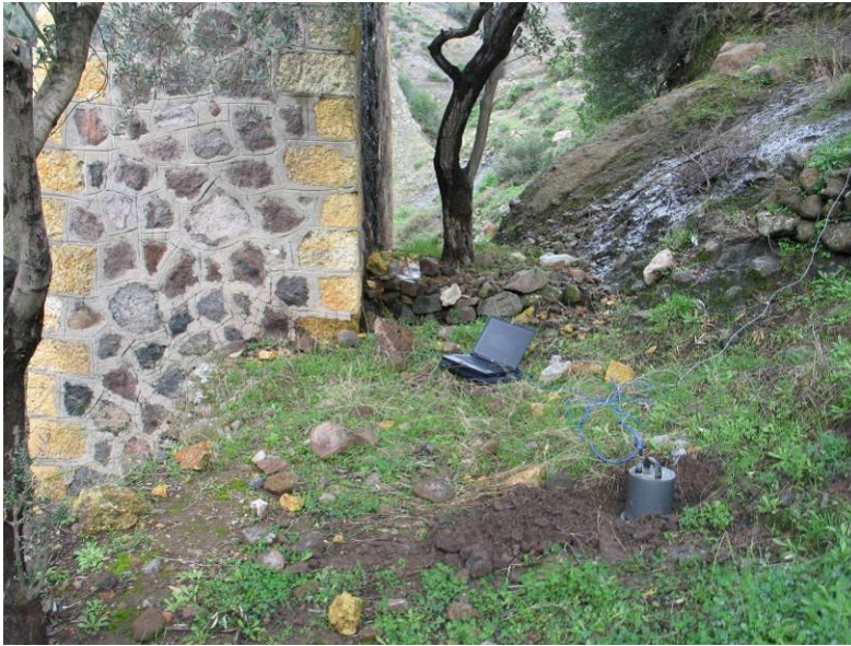
Şekil 5.59. Zeytinler Köprüsü mikrotremor ölçümü
