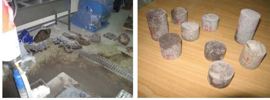
Şekil 5.14. Hazırlanmış karot numuneleri
