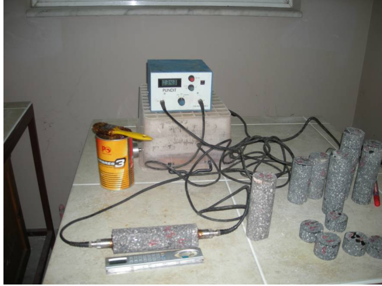
Şekil 5.38. Ultra ses darbe testi
