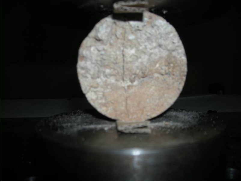
Şekil 5.35. Yarmada çekme testi
