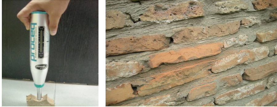
Şekil 5.31. Tuğlaya uygulanan Schmidt testi
