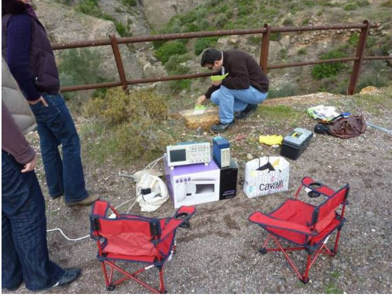
Şekil 5.86. Zeytinler’de bulunan kemer köprü üzerinde darbe-eko testi
