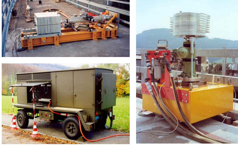
Şekil 4.7. Hidrolik titreştirici ve hidrolik donanımı (Cantieni, 2004)
