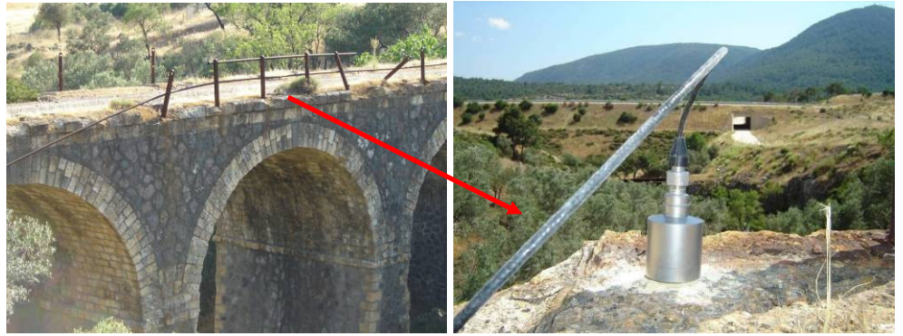
Şekil 5.74. 0–50 Hz aralığındaki titreşimlere duyarlı, 10 V/g hassasiyetinde ivmeölçer
