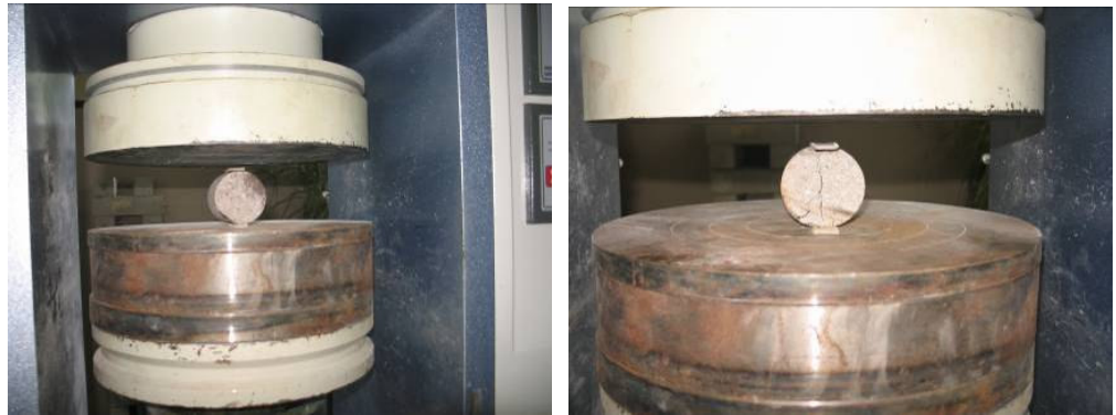
Şekil 5.20. Yarmada çekme testi
