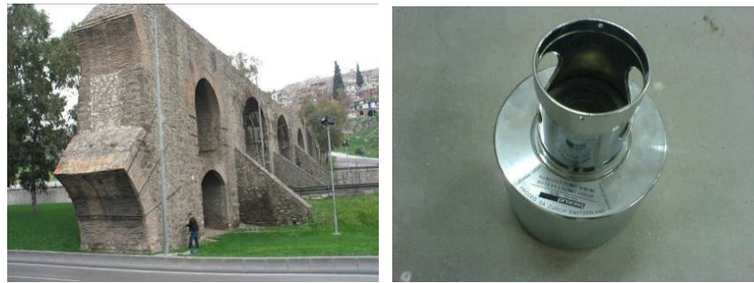
Şekil 5.15. Vezir Su Kemerı Schmidt çekici testi ve kalibrasyon kovası
