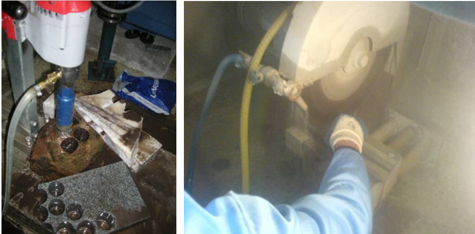
Şekil 5.13. Karot alma ve numunelerin kesilmesi
