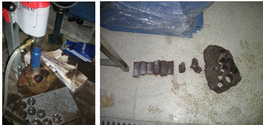
Şekil 4.18. Karot numunelerinin laboratuarda alınması
