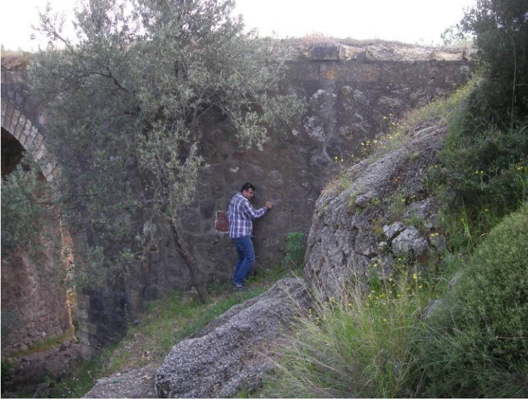
Şekil 5.37. Kemer köprü Schmidt çekici testi
