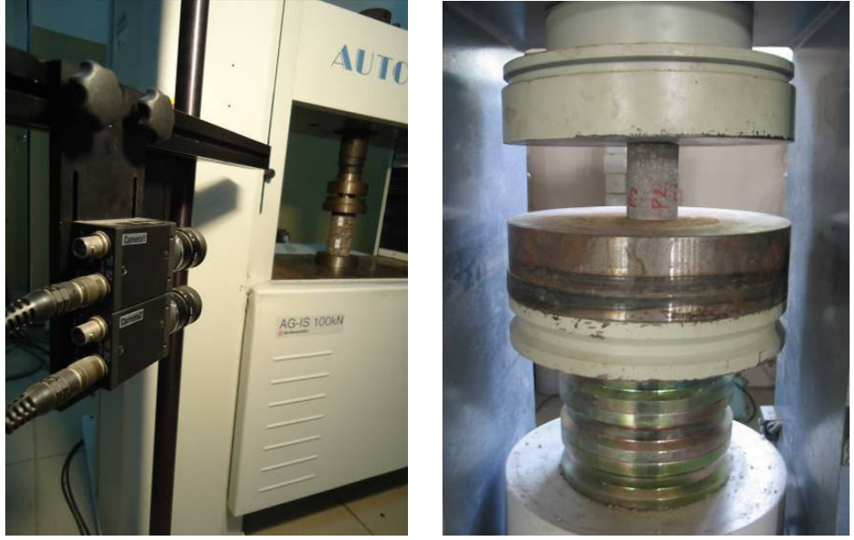
Şekil 5.19. Deplasman kontrollü ve yük kontrollü yükleme cihazları
