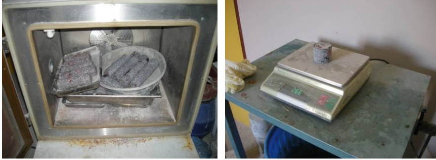
Şekil 5.18. Etüvde kurutulan numuneler ve Arşimet terazisi
