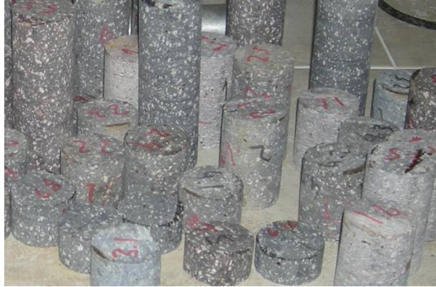
Şekil 5.36. Hazırlanmış karot numuneleri
