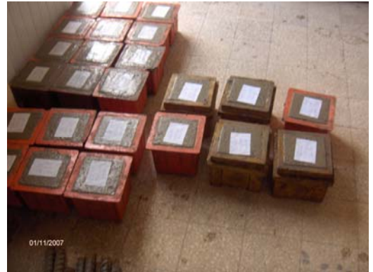
Şekil 4.1 Beton küp örneklerinin ( 15 \times 15 \times 15 \text{ cm}^3 ) hazırlanma basamakları
