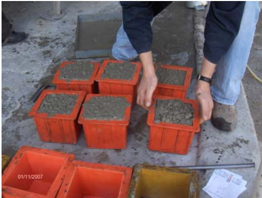
Şekil 4.1 Beton küp örneklerinin ( 15 \times 15 \times 15 \text{ cm}^3 ) hazırlanma basamakları
