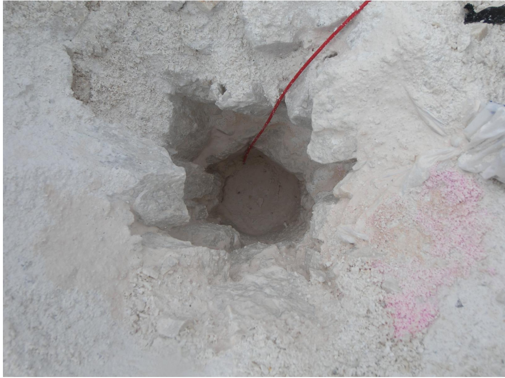
Şekil 3.13. Alçı ile sıkılanmış bir deliğin görüntüsü
