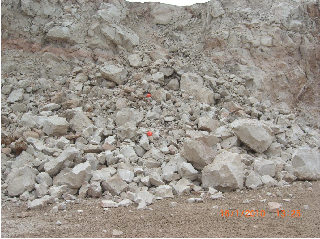
Şekil 4.6. Standart fotoğraf yöntemiyle atım VI'nın değerlendirilmesi
