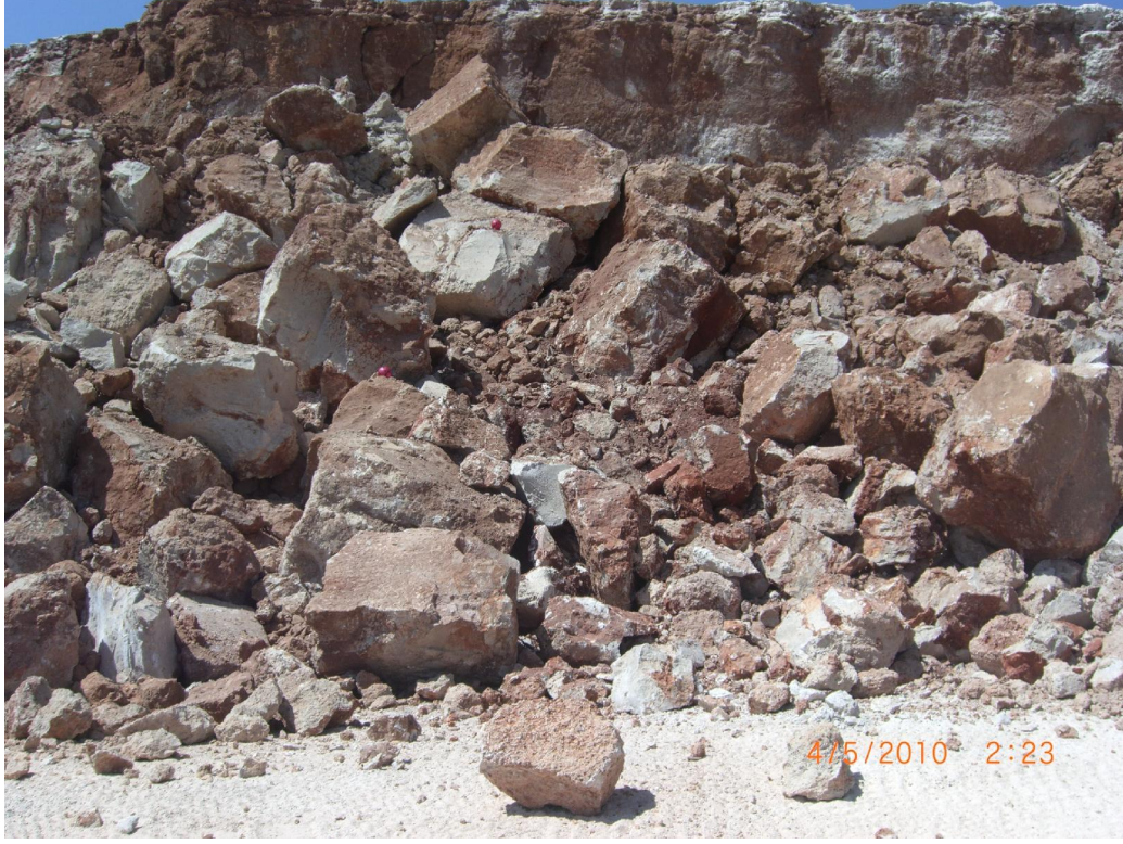
Şekil 4.13. Standart fotoğraf yöntemiyle atım XIII'ün değerlendirilmesi
