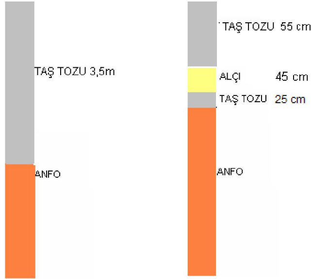
a) Taş tozu sıkılaması b) Alçı sıkılamalı yöntem
