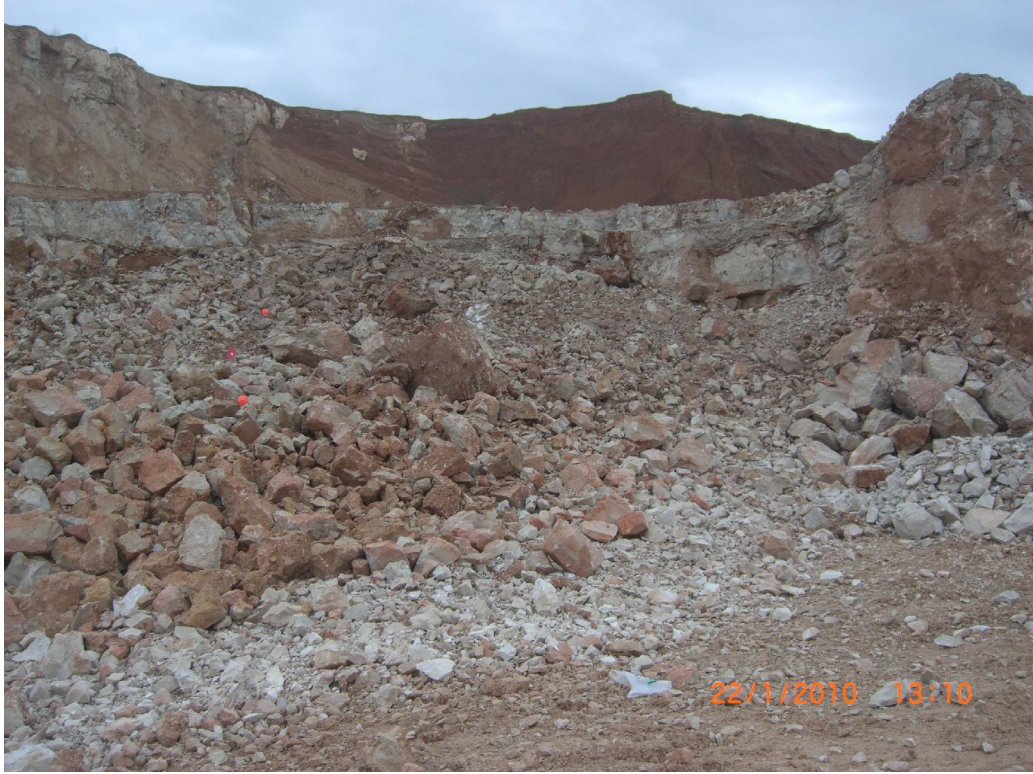
Şekil 4.9. Standart fotoğraf yöntemiyle atım IX'un değerlendirilmesi
