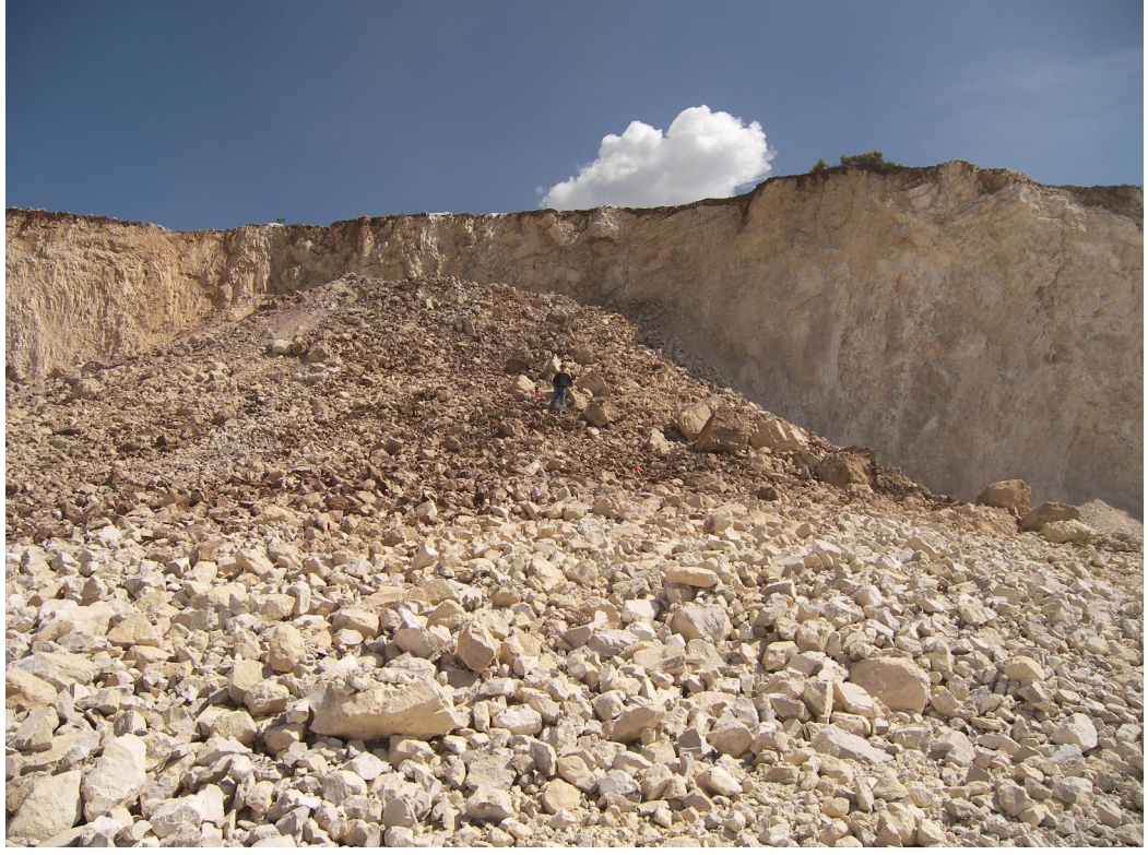
Şekil 4.24. Standart fotoğraf yöntemiyle taş tozu sıklamalı atımın değerlendirilmesi
