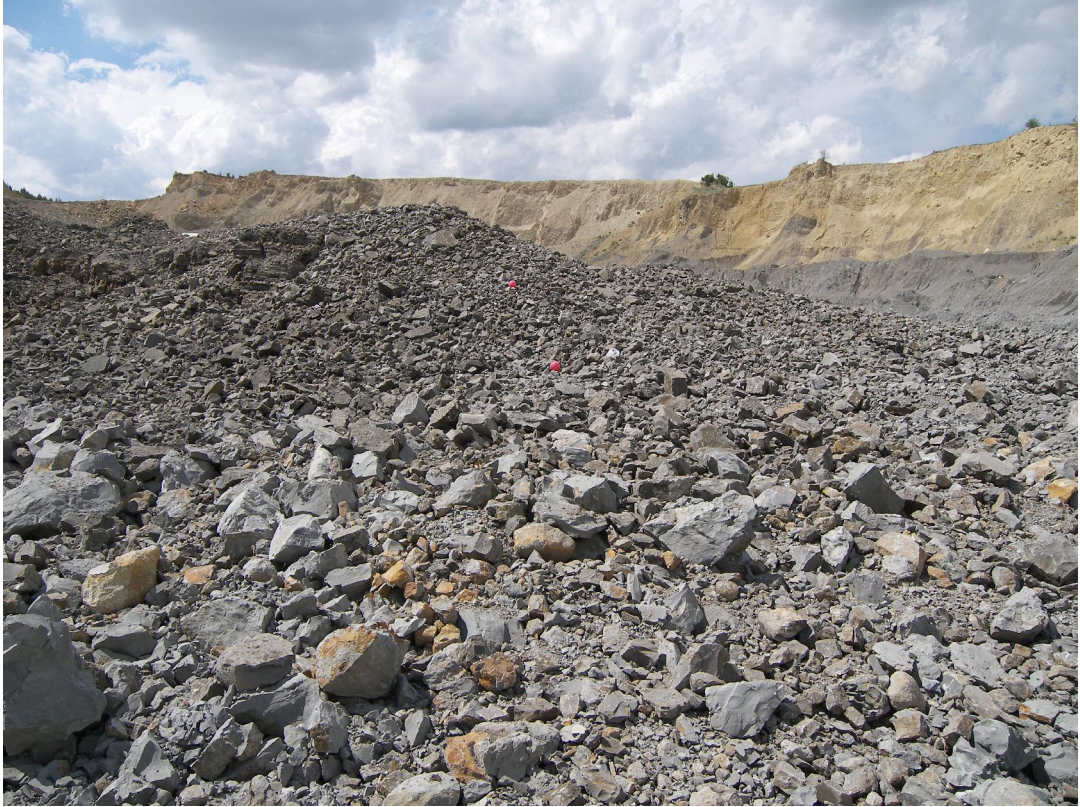
Şekil 4.23. Standart fotoğraf yöntemiyle alçı sıkılamalı atımın değerlendirilmesi
