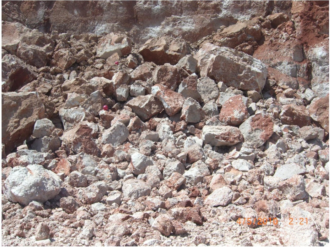
Şekil 4.12. Standart fotoğraf yöntemiyle atım XII'nin değerlendirilmesi
