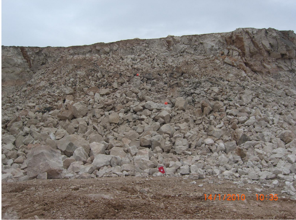
Şekil 4.1. Standart fotoğraf yöntemiyle atım I'in değerlendirilmesi
