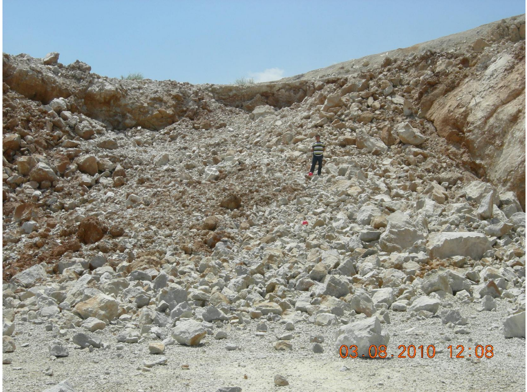
Şekil 4.26. Standart fotoğraf yöntemiyle taş tozu sıkılamalı atımın değerlendirilmesi
