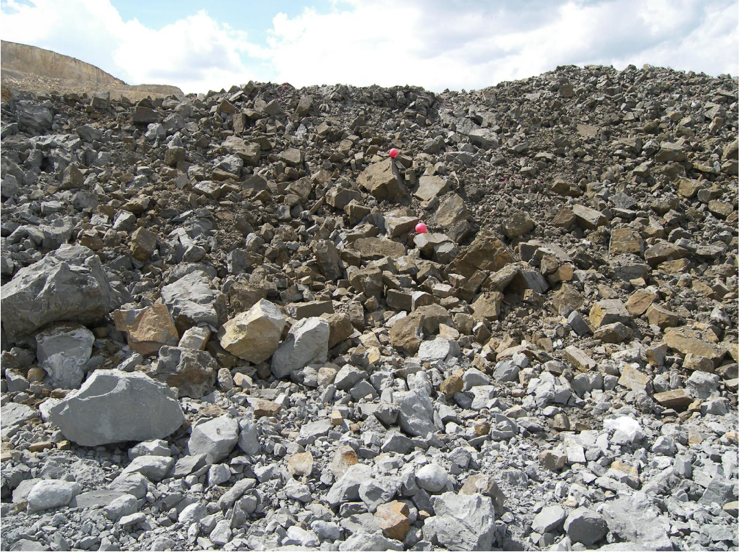
Şekil 4.22. Standart fotoğraf yöntemiyle taş tozu sıkılamalı atımın değerlendirilmesi
