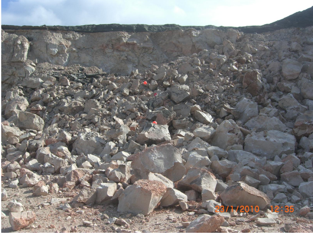
Şekil 4.10. Standart fotoğraf yöntemiyle atım X'un değerlendirilmesi
