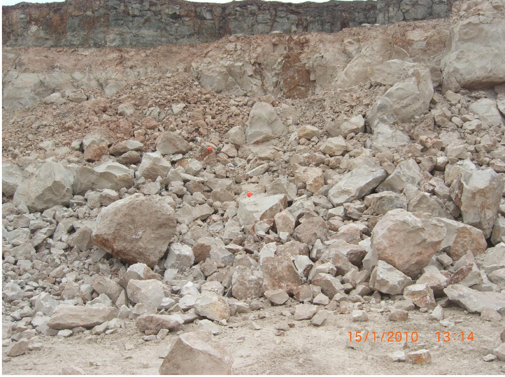
Şekil 4.3. Standart fotoğraf yöntemiyle atım III'ün değerlendirilmesi
