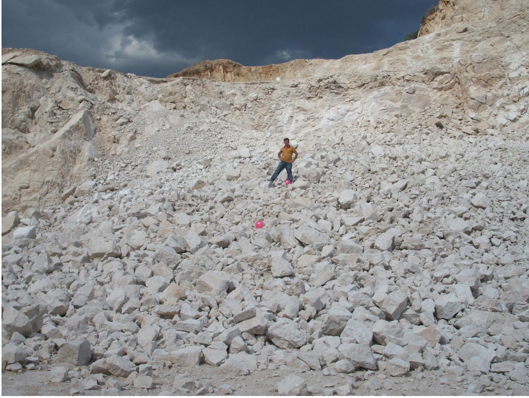
Şekil 4.18. Standart fotoğraf yöntemiyle taş tozu sıkılamalı atımın değerlendirilmesi
