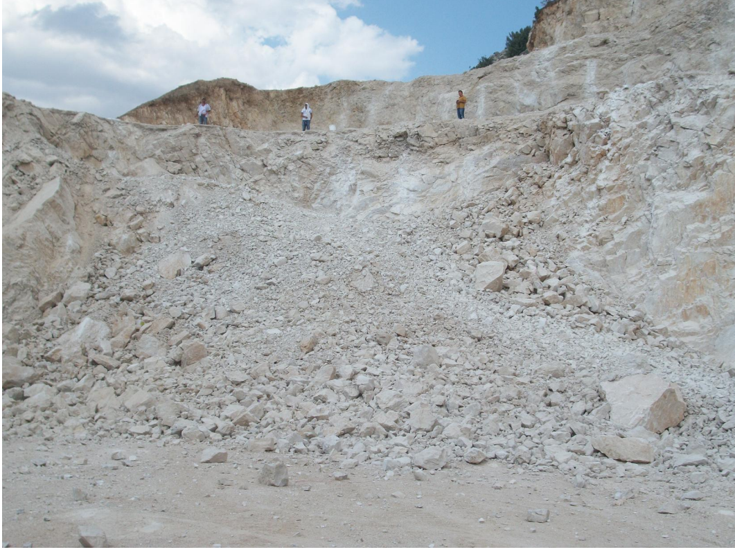
Şekil 4.19. Standart fotoğraf yöntemiyle alçı sıkılamalı atımın değerlendirilmesi
