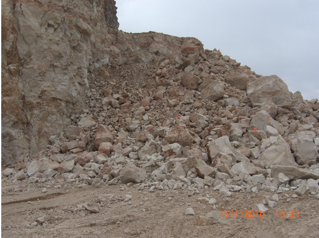
Şekil 4.4. Standart fotoğraf yöntemiyle atım IV'ün değerlendirilmesi
