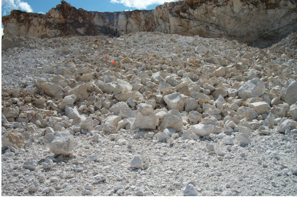
Şekil 4.15. Standart fotoğraf yöntemiyle Gümüşgün atım I' in değerlendirilmesi
