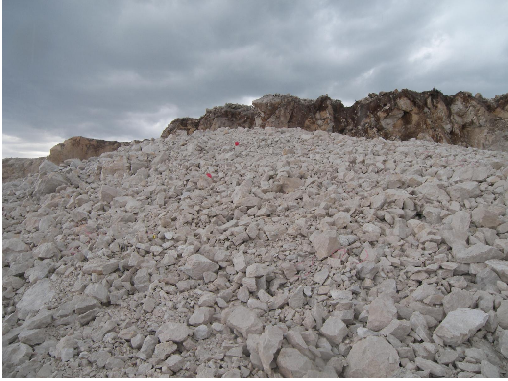
Şekil 4.17. Standart fotoğraf yöntemiyle alçı sıkılamalı atımın değerlendirilmesi
