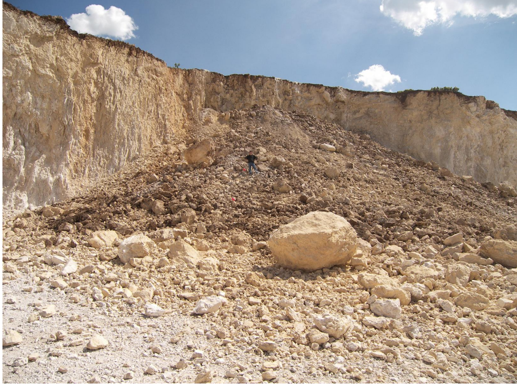
Şekil 4.25. Standart fotoğraf yöntemiyle alçı ile sıkılanan atımın değerlendirilmesi
