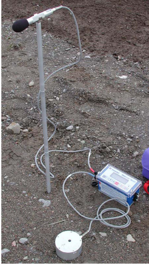
Şekil 3.9. Instantel Minimate Blaster cihazı ve aksesuarları
