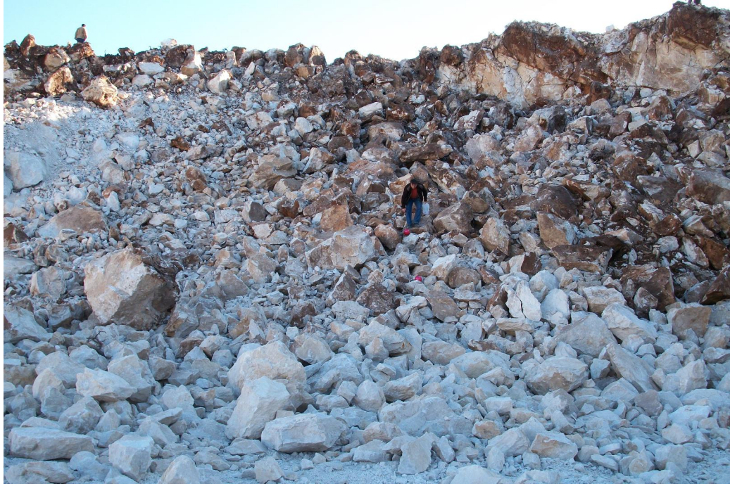
Şekil 4.16. Standart fotoğraf yöntemiyle Gümüşgün Atım II'nin değerlendirilmesi
