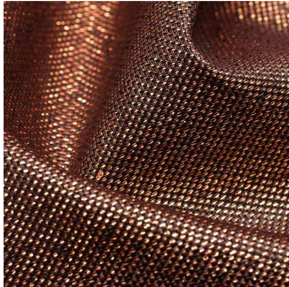
Resim 4.14: İç mekan tekstil ürünü olarak kullanılma üzere, metalik ve naylon monofilamenlerden üretilmiş, UV ışınlarına ve ateş(yanmaya) dayanıklı kumaş tasarımı. 154
