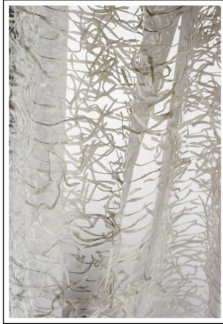
Resim 3.92: Dokuma sırasında atkıdan el yapımı Mino kağıt parçaları eklenmiş ve daha sonra elle kesilmiş Yaburegami 134 (Patched Paper) isimli polyester düz dokuma kumaş.
