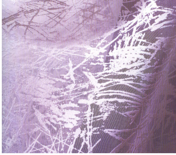
Resim 3.34: Reiko Sudo'nun tasarladığı Nuno tekstil tarafından üretilen %100 polyester Graffiti 62 isimli bu kumaş tasarımında; rölyef görünümünde bir yüzey yaratmak için flok tekniği ve pigment boyar maddeler birleştirilerek baskı uygulanmıştır.
