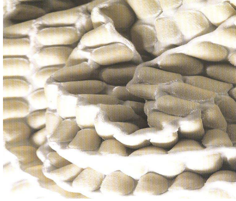
Resim 3.30: Sculpted Rayon Velvet 58 isimli bu dokulu kumaş tasarımında; Rayon kadife kumaşın yüzeyine yapıştırıcı bir madde ile baskı yapılmış ve yüksek ısıya maruz bırakılarak bir bitim işlemi uygulandığında bu yüzey elde edilmiştir.
