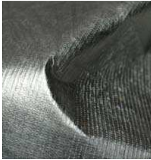
Resim 3.50: Esnek, dayanıklı, hafif, opak, metalize yüksek yoğunluklu polietilen (HDPE) kullanılan, spunbonded yöntemiyle üretilmiş, July 09 Material Up Date kataloğunda MC#: 1930-03 kodlu ürün 86 koduyla yer alan nonwoven (dokumasız) Tyvek kumaş tasarımı.
