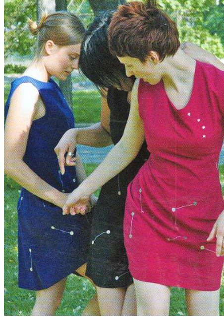
Resim 3.56: Elektronik ve sosyal ilişkiler kurmak anlayışından (konseptinden) yola çıkarak, insanları mekanik ve elektronik olarak bir araya getirmenin amaçlandığı The Constellation Dresses 95 isimli bu tasarımda, giysinin gövde ve basen bölgelerine takımyıldızı görüntüsü içerisinde on iki manyetik çitçit ve ışık yayıcı diyotlar, tek sıra iletkin bir ip ile bağlanarak yerleştirilmiştir. Çitçitlerin bir kısmı LED devresi için açma/kapama düğmesi görevi görür ve başka bir giysideki çitçitlerle birleştirildiklerinde ise giysi üzerindeki devre kapalı hale gelir ve LED'ler yanmaya başlar.
