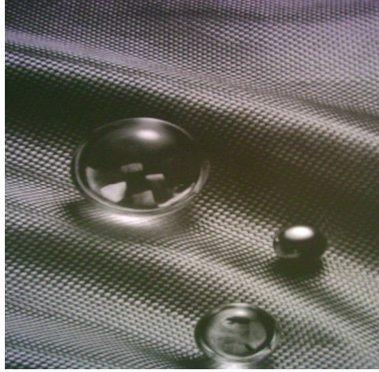
Resim 3.40: Poliakrilonitril (PAN) lifleri yüksek ısıda kömürleştirilmesiyle elde edilen karbon liflerden üretilen, kaplama maddesinin kumaşın yüzeyine nanoteknoloji kullanılarak uygulandığı Mitsubishi Rayon tarafından üretilen Pyrofil 70 isimli kumaş tasarımı.
