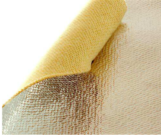
Resim 3.42: Dual Mirror Aluminized 72 isimli tasarım. Aramid, fiberglas, preox, suni ipek gibi ürünleri olan Gentex firması daha çok aluminize yöntemiyle kumaşlara kaplama işlemi uygulamaktadır. Alüminyum kaplamayla kumaşların performansları artmakta, görünümleri değişmekte ve çevresel etkilere karşı direnç kazanmaktadır. Günümüz teknolojiyle uygulanan bu kaplama yöntemi kumaşa güç tutuşurluk, ısı koruyuculuk, ısı ve güneş ışığına karşı direnç gibi performans özellikleri kazandırmaktadır. 73
