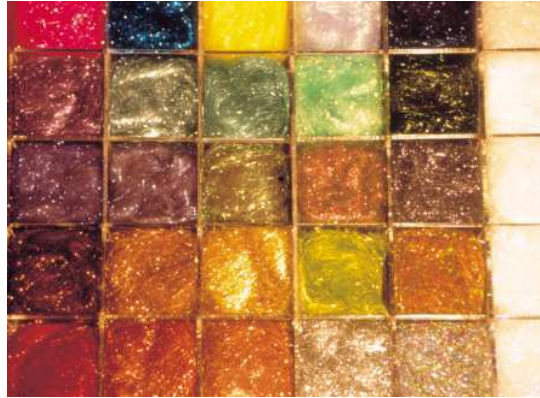
Resim. 3.8. Meadowbrook Inventions firması tarafından üretilen özel optik efektli, kaşmir veya mücevher etkisinde görünümüne sahip, parlak Angelina lifleri. 29
