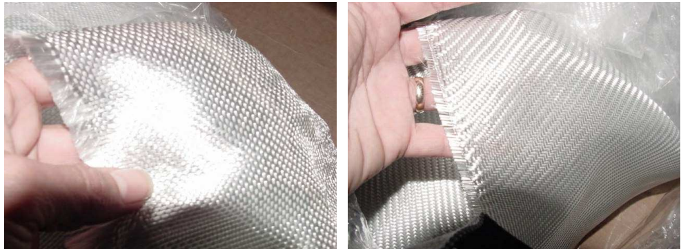
Resim 3.23: Cam lifiyle dokunmuş örgü yapıları farklı olan kumaş örnekleri 49
