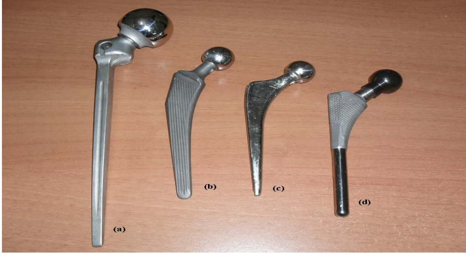
Şekil 3-1: Çalışmada kullanılan kalça protezleri [a) titanyum (48 mm), b) titanyum (28 mm), c) CoCrMo (28 mm), d) paslanmaz çelik (26 mm)]
