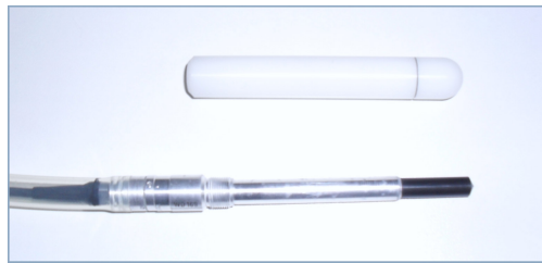
Şekil 3-7: Çalışmada kullanılan 0,6 cc iyon odası
