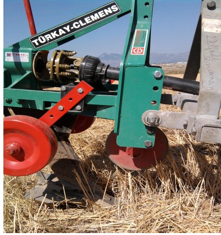
Şekil 3.2. Denemede kullanılan ünite kombinasyonlu (disk-keski) dipkazan
