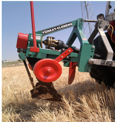
Şekil 3.3. Denemede kullanılan ünite kombinasyonlu (bıçak-keski) dipkazan
