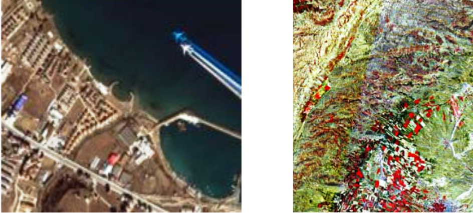
Şekil 2.20. Solda 1 m çözünürlükteki İkonos görüntüsü (Trabzon), Sağda 20 m çözünürlükteki Spot-5 görüntüsü (Lübnan), [İnta Space Türk].
