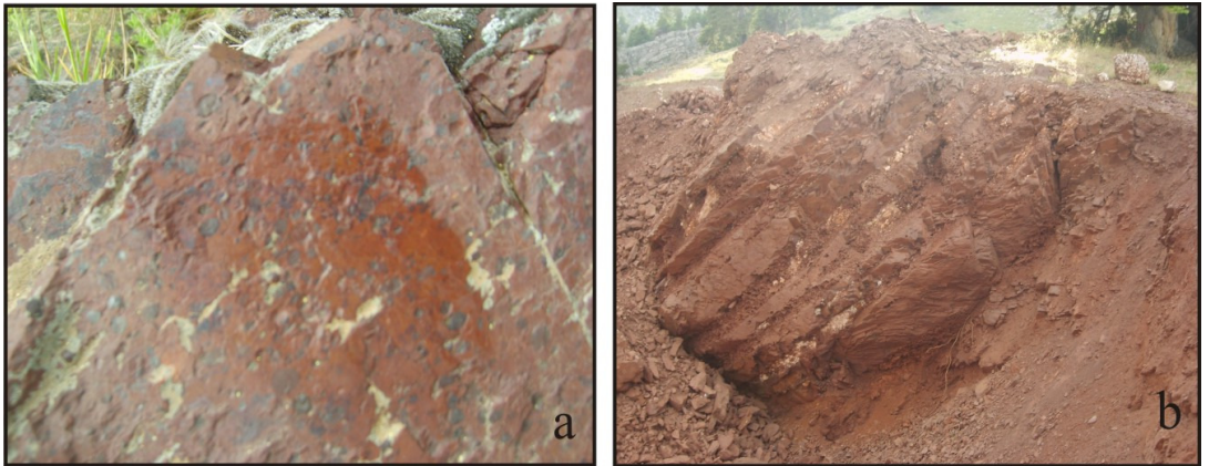
Şekil 2.13. Morçukur yatağında gözlenen boksit yapıları (a) oolitik-pizolitik, (b) tabakalı boksit.
