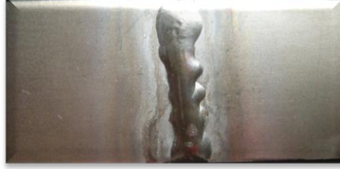
Şekil 5.3. TIG kaynağı uygulanmış titanyuma ait kaynak dikişi
