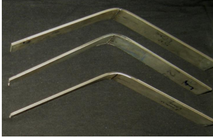
Şekil 5.21. Lazer kaynaklı numunelerin eğme deneyleri sonundaki durumları
