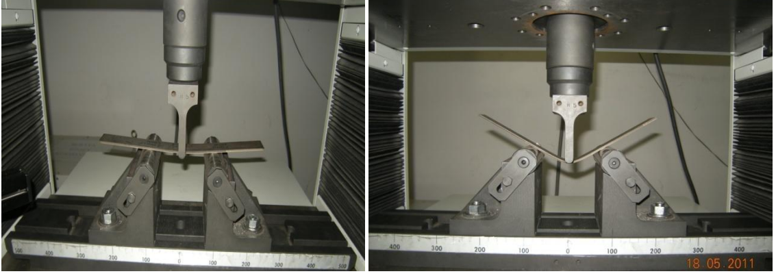
Şekil 5.17. Üç nokta eğme deneyi aşamasına ait görüntüler
