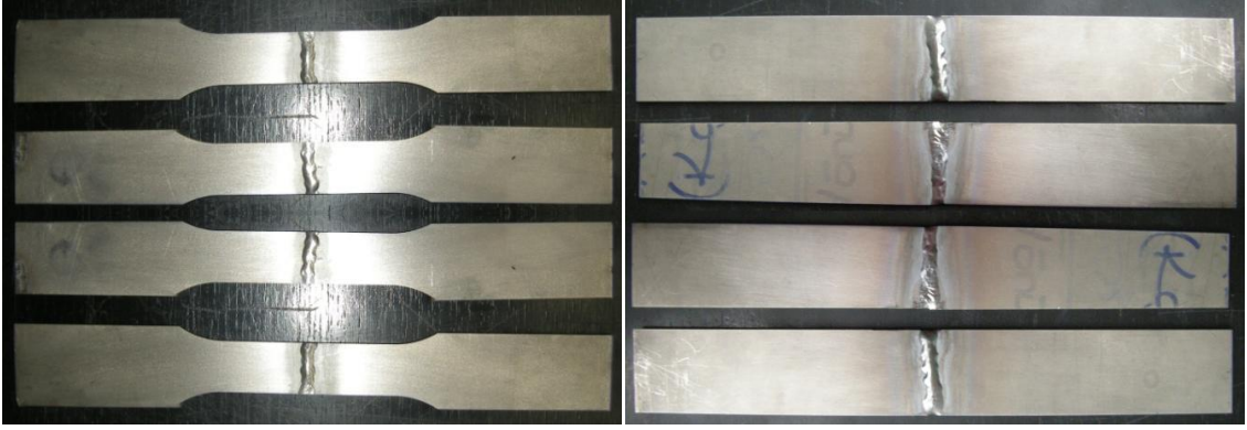
Şekil 5.9. TIG kaynaklı malzemeye ait çekme ve eğme numuneleri
