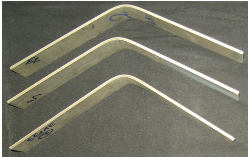
Şekil 5.19. Esas malzemeye ait numunelerin eğme deneyleri sonundaki durumları
