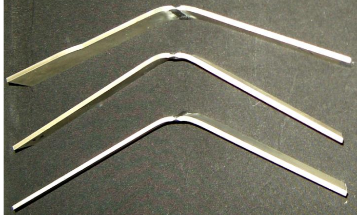
Şekil 5.23. TIG kaynaklı numunelerin eğme deneyleri sonundaki durumları
