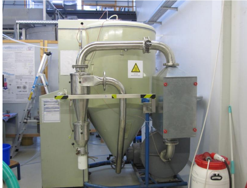
Şekil 3.1 Pilot ölçekli püskürtmeli kurutucu (C117 Industrie-Werke-Karlsruhe, Almanya)
