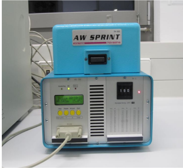
Şekil 3.2 Su aktivitesi lüm cihazı (TH-500, Novasina, İsvire)
