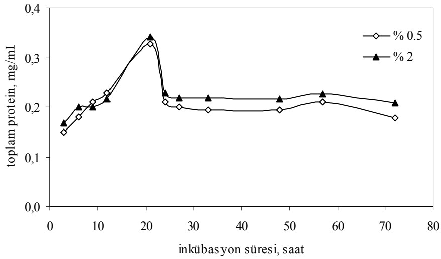
Şekil 5.26. Farklı konsantrasyonlarda zeytin yağı içeren fermantasyon ortamlarında protein konsantrasyonunun zamanla değişimi (pH: 6, T:30 °C, KH: 150 rpm, aşı oranı: % 10 v/v)
