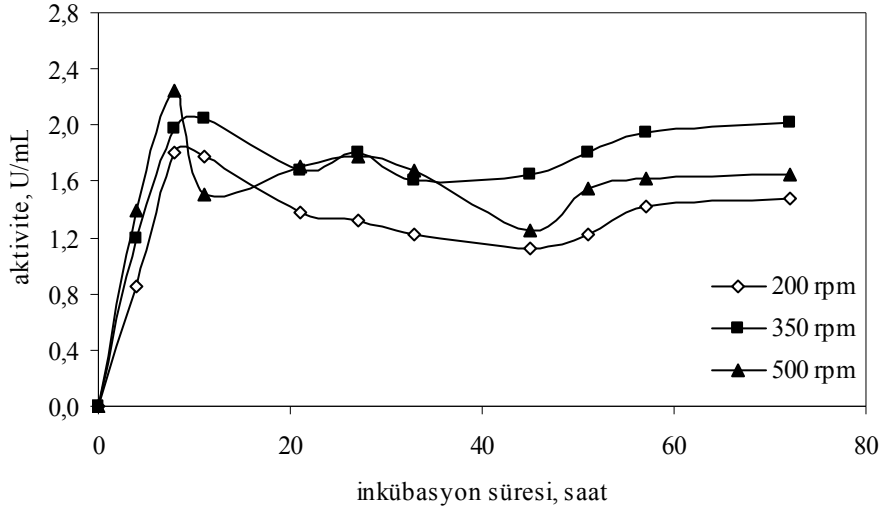
Şekil 5.69. Farklı karıştırma hızlarında enzim aktivitesinin zamanla değişimi (% 1 mısır yağı, % 0.4 pepton, pH: 6, T: 30 °C, hava akış hızı: 0.2 vvm, aşı oranı: % 10 v/v)
