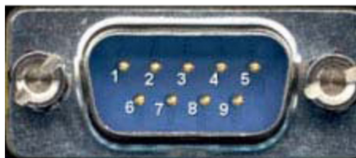
ekil 3.6. RS-232 9 Pin'li Di i Seri Port'un Fiziksel Görünü ü ve Yapısı
