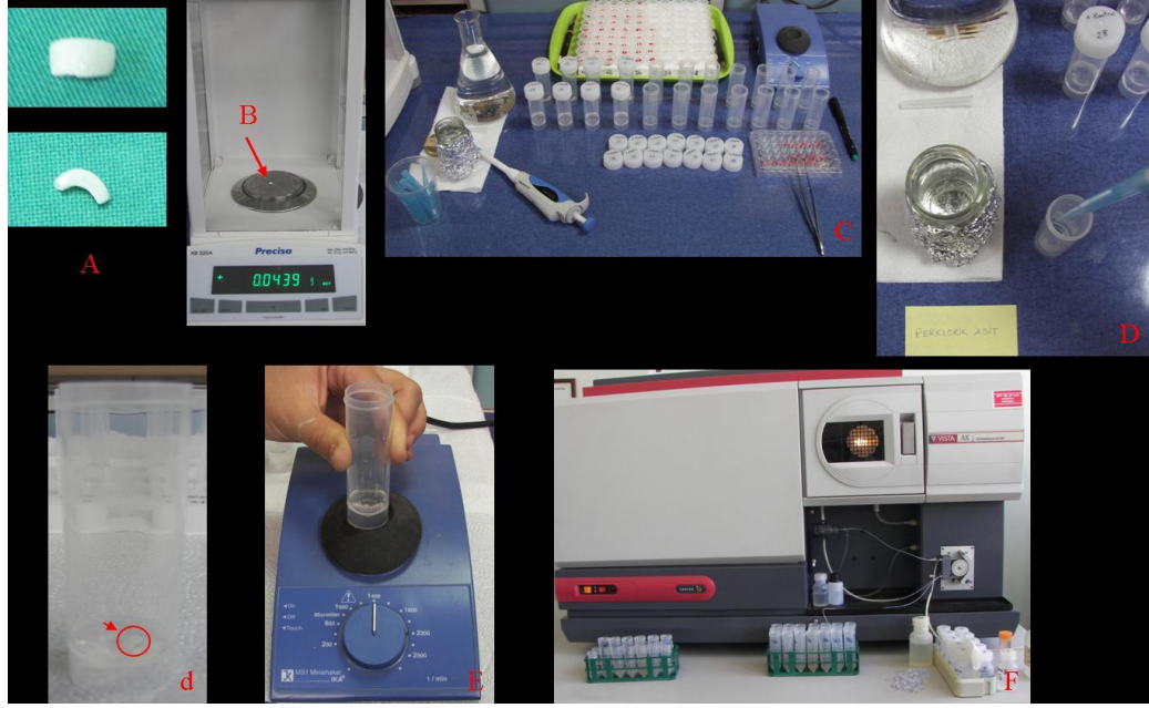
Resim 2.15. A.a. Kesilip çıkarılan mine örneği. B. Örneklerin ağırlıklarının hassas terazi ile ölçülmesi. C. Örneklerin asit biyopsisi yöntemi için hazırlanması. D. Polipropilen tüplere 2 ml perklorik asit koyulması; d. Tüpün içerisindeki bir numune. E. Minishaker'da çalkalanması. F. ICP-AES cihazında ölçüm işlemi.
