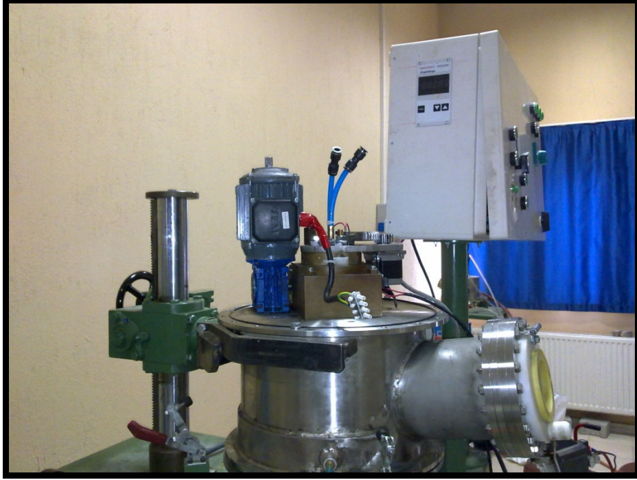
Resim 3. 4 Tungsten uçların hareketini sağlayan kısım
