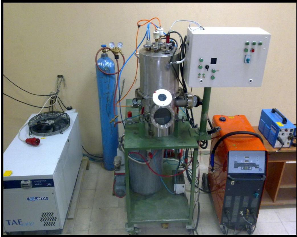
Resim 3. 3 Vakum ark ergitme ve döküm fırını
