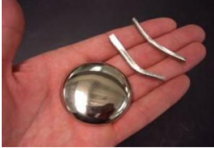
Resim 2. 2 Ti bazlı bir metalik camın yüzey kalitesi
