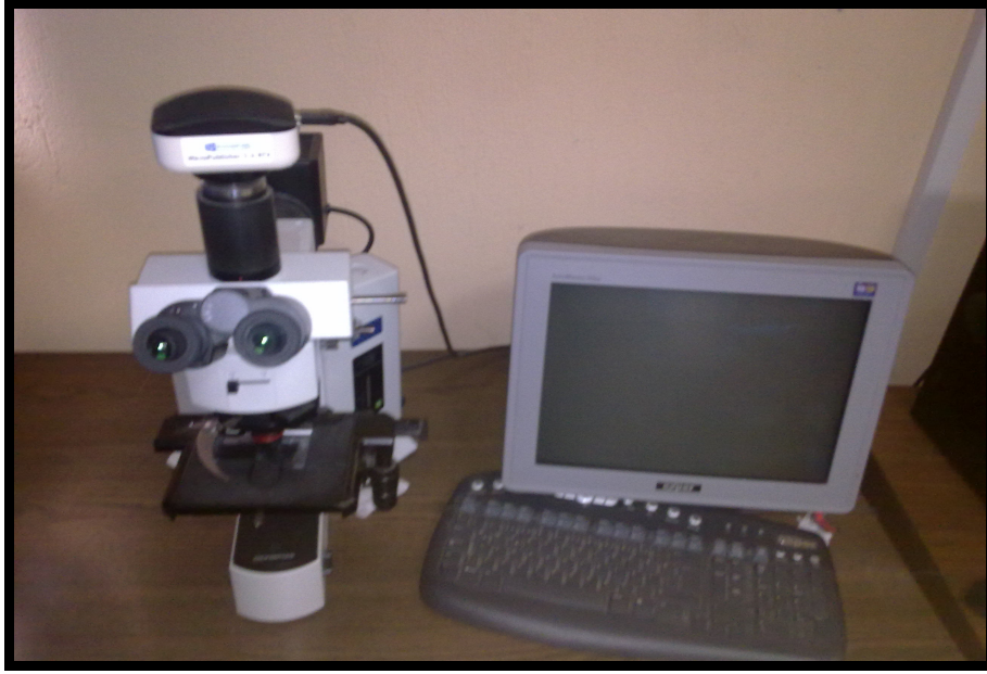
Resim 3. 7 Polarize optik mikroskop
