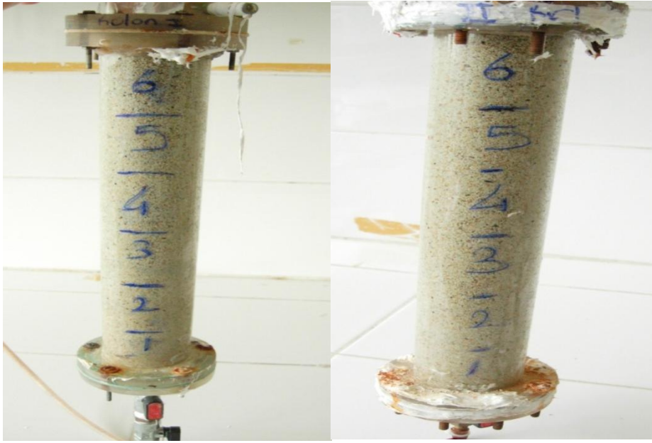
Şekil 6.56. İkinci grup çalışmada kullanılan biyobariyerlerin kaplanmadan önceki görüntüleri.
