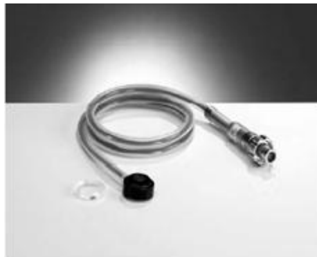
Şekil 3-8: PTW 23343 model Markus paralel plak iyon odası
