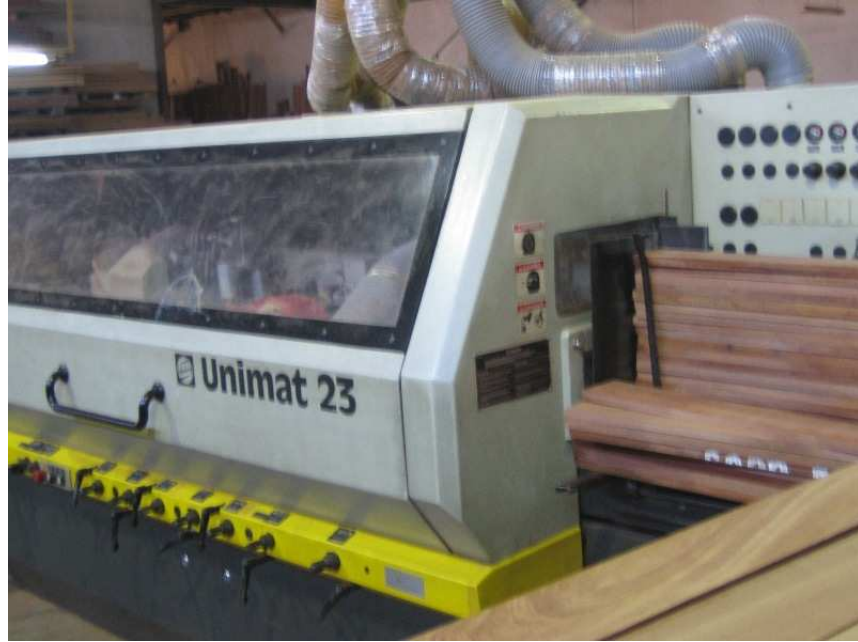
Şekil 4.14: Endüstriyel Uygulama Örneği 1'de bulunan parke yan makinası (Foto: Güngör).
