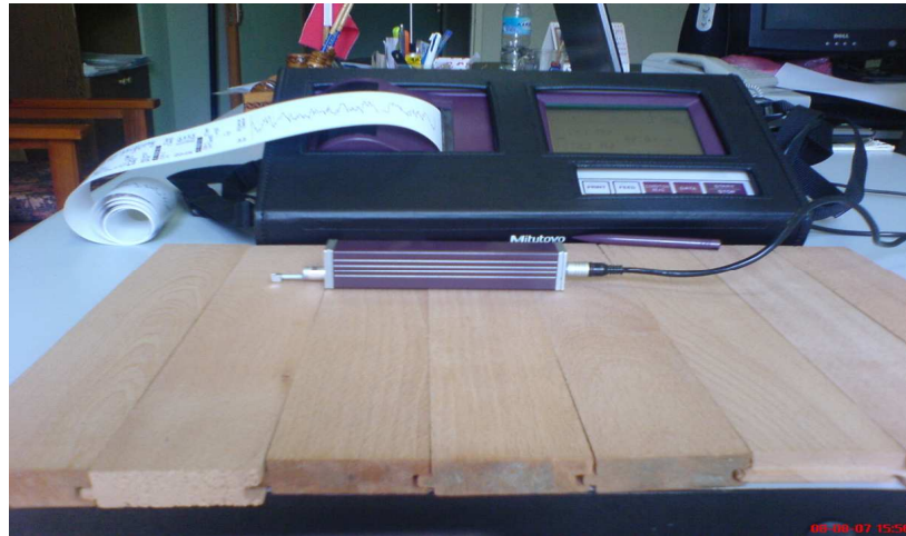
Şekil 3.9 :Yüzey pürüzlülük ölçüm aleti (Mitutoyo SJ-301) (Foto:Korkut).
