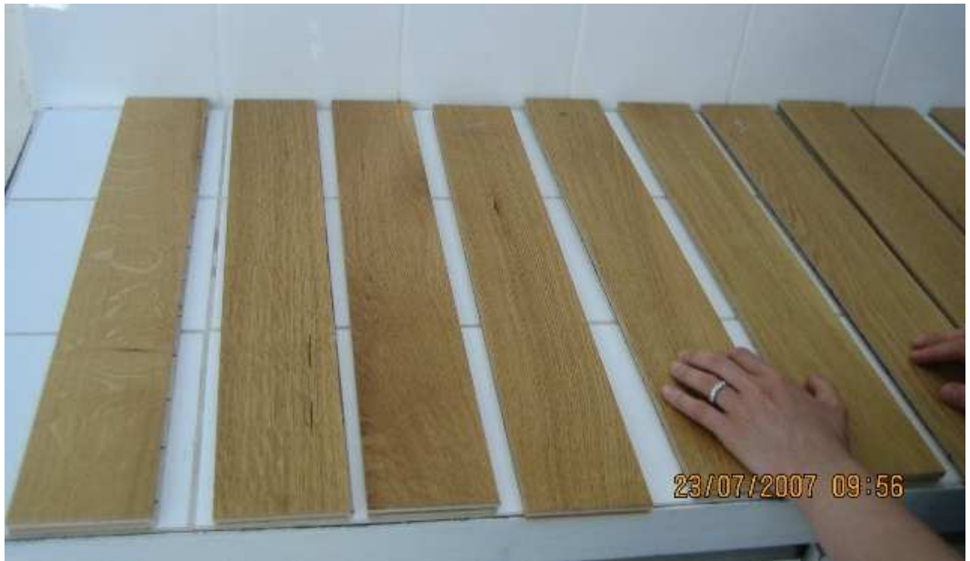
Şekil 3.6: Çok tabakalı parkelerin görünüm özellikleri bakımından TS EN 13489 (2004)'e uygunluğunun gözle muayenesi (Foto: Kantay).
