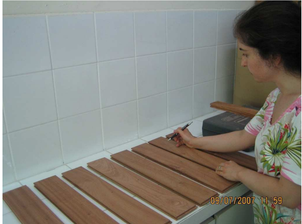
Şekil 3.2:Masif parkelerin görünüm özellikleri bakımından TS 73 EN 13226 (2004)'e uygunluğunun gözle muayenesi (Foto: Kantay).
