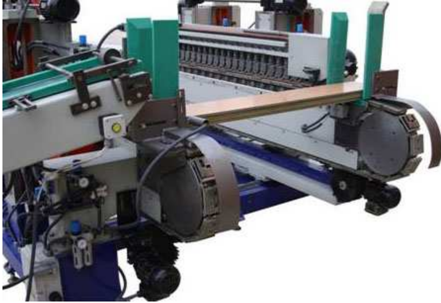
Şekil 2.13 : Çok tabakalı parke üretim hattında kullanılan parke baş makinası (Sabri Yaman, 2008).
