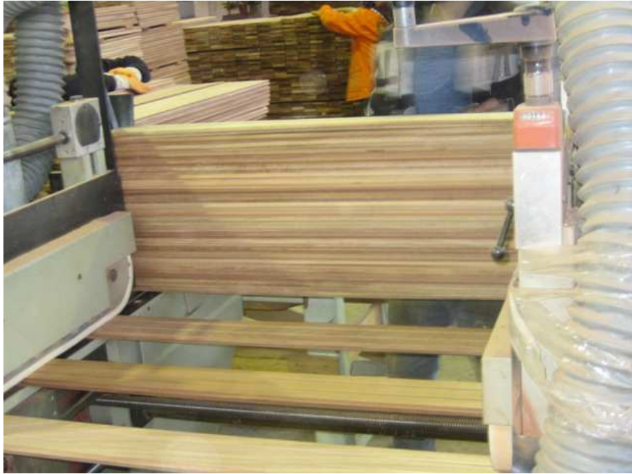
Şekil 4.15: Endüstriyel Uygulama Örneği 1’de bulunan parke baş makinası (Foto: Güngör).
