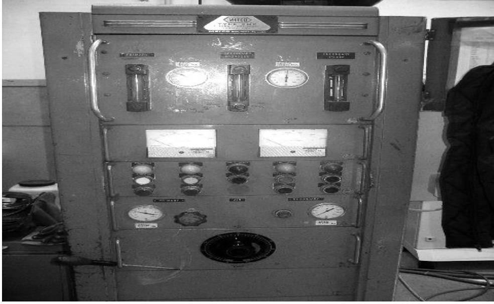
Şekil 6.5. Atmosferik Plazma Püskürtme Sisteminin Güç Kaynağı [87].
