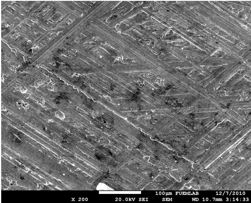
Şekil 8.41. Zn-15Cu-20Al-5O-5C Aşınma Sonrası SEM Görüntüleri a) 75X b) 200X
