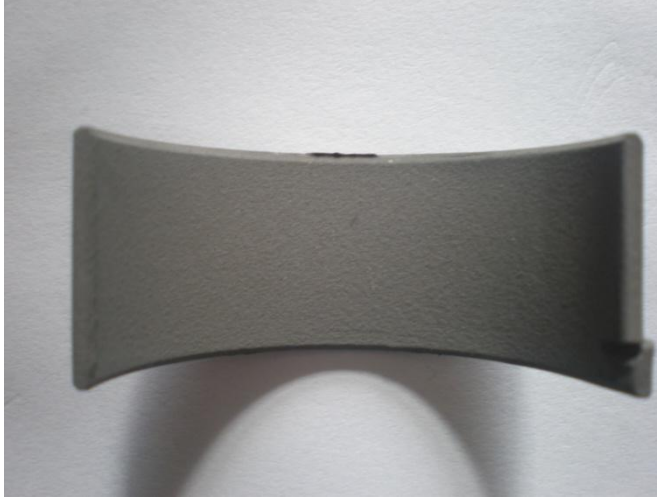
Şekil 7.5. Kaplanmış Yatağın Üstten İç Yüzeyinin Görünümü.
