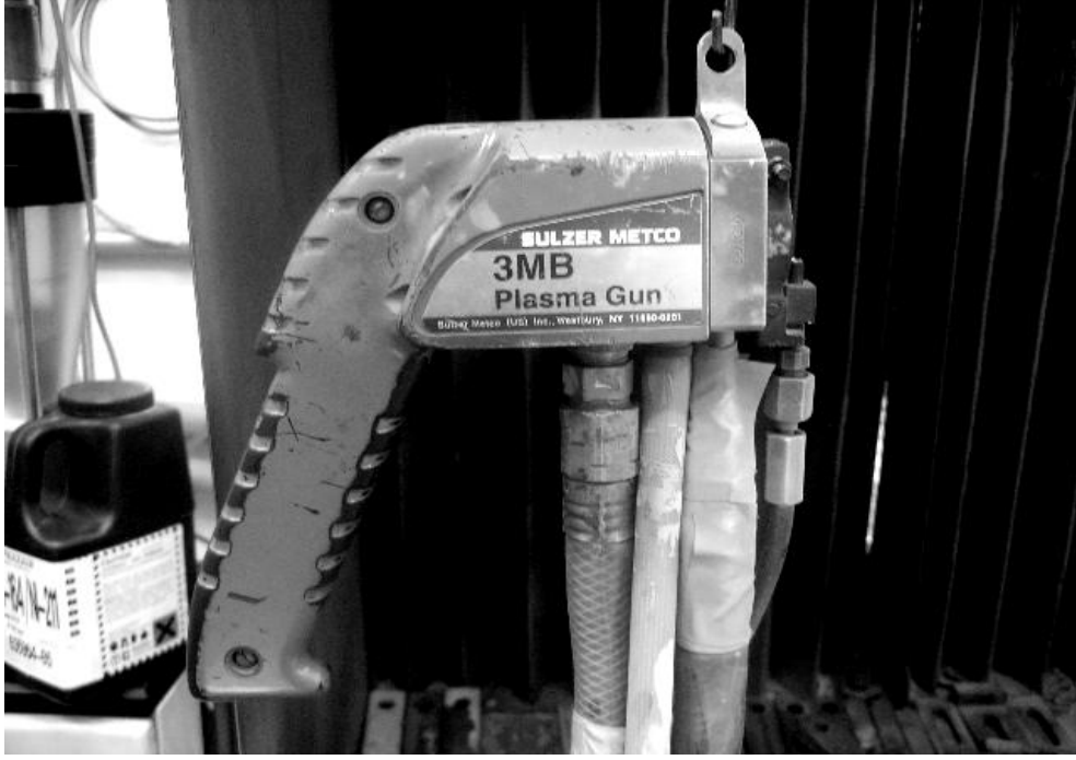
Şekil 6.7. Atmosferik Plazma Püskürtme Sisteminin Plazma Tabancası [87].
