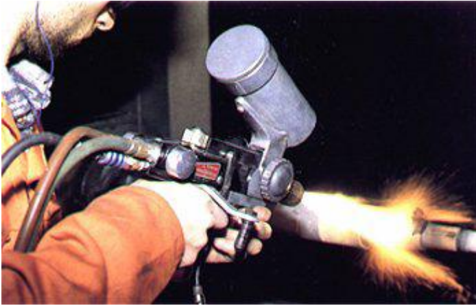
Şekil 5.3. Alevle Toz Püskürtme ile Gerçekleştirilen Kaplama İşlemi [12].
