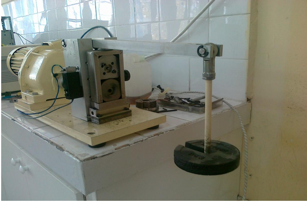
Şekil 7.7. PLINT Marka Ring on Ring Aşınma Cihazı.
