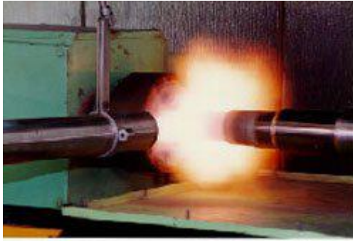
Şekil 5.6. Silindirik Altlık Malzemesinin Patlamalı Püskürtme Yöntemiyle Kaplanması [87].
