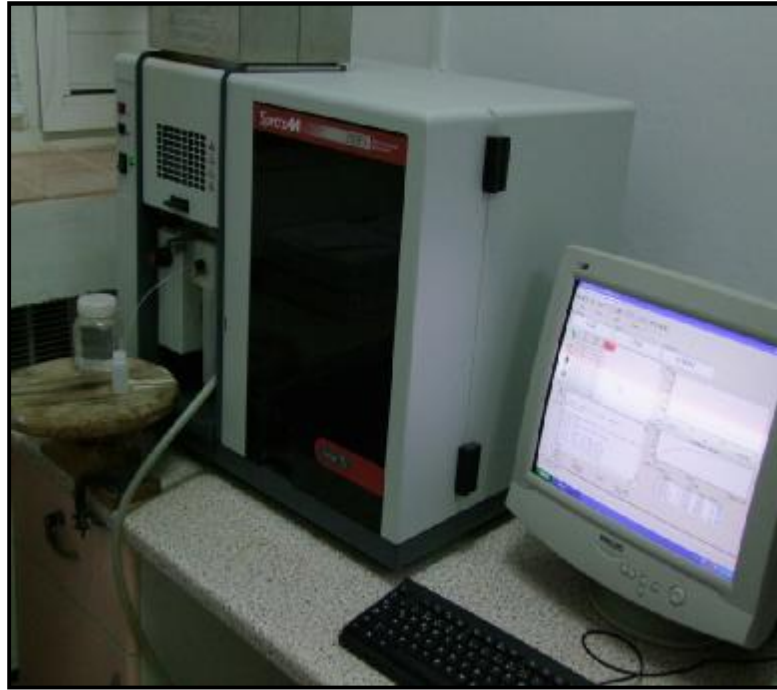
Şekil 3.8. Atomik Absorbsiyon Spektrofotometre cihazında element okumaları
