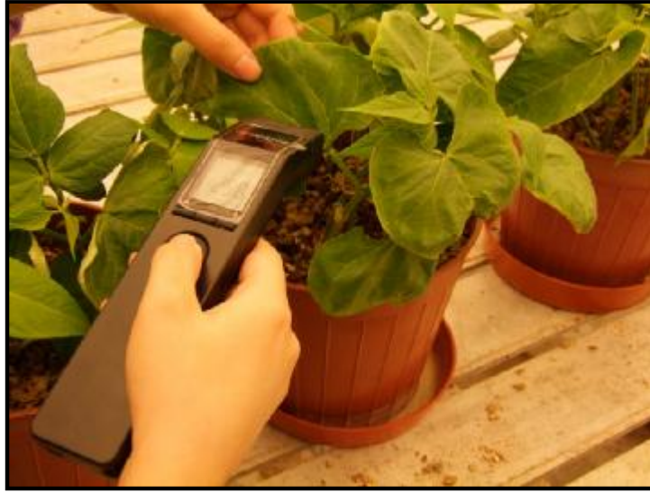
Şekil 3.10. Yaprak sıcaklığının ölçülmesi
