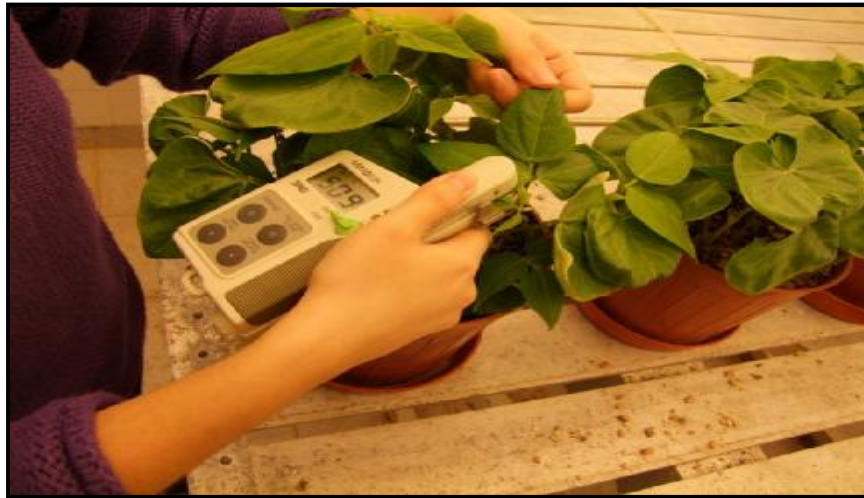
Şekil 3.13. SPAD metre ile genotiplerin klorofil miktarının belirlenmesi
