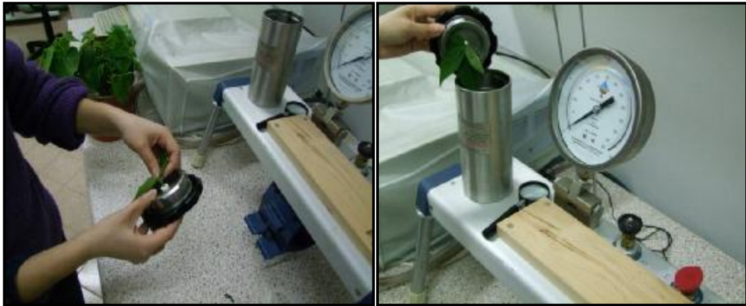
Şekil 3.9. Basınç çemberinde yaprak su potansiyelinin belirlenmesi
