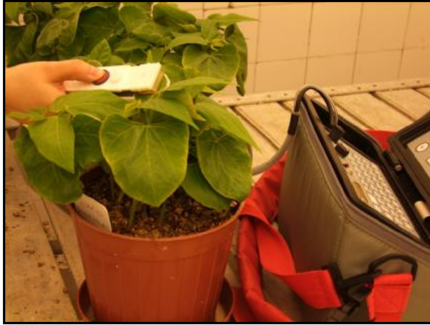
Şekil 3.11. Porometre ile stoma geçirgenliğinin belirlenmesi
