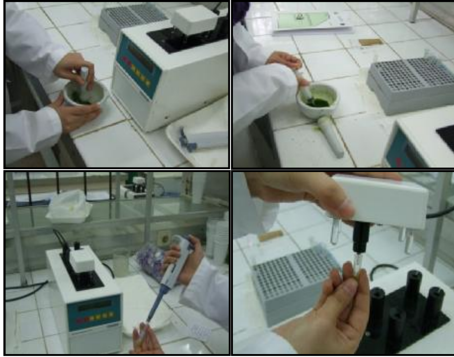
Şekil 3.12. Ozmometre ile yaprak ozmotik potansiyelinin belirlenmesi
