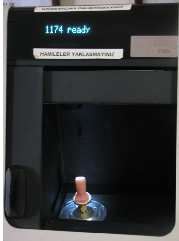
Resim 13: Tarama için mikro bilgisayarlı tomografi ( \mu CT) cihazına örneklerin yerleştirilmesi
