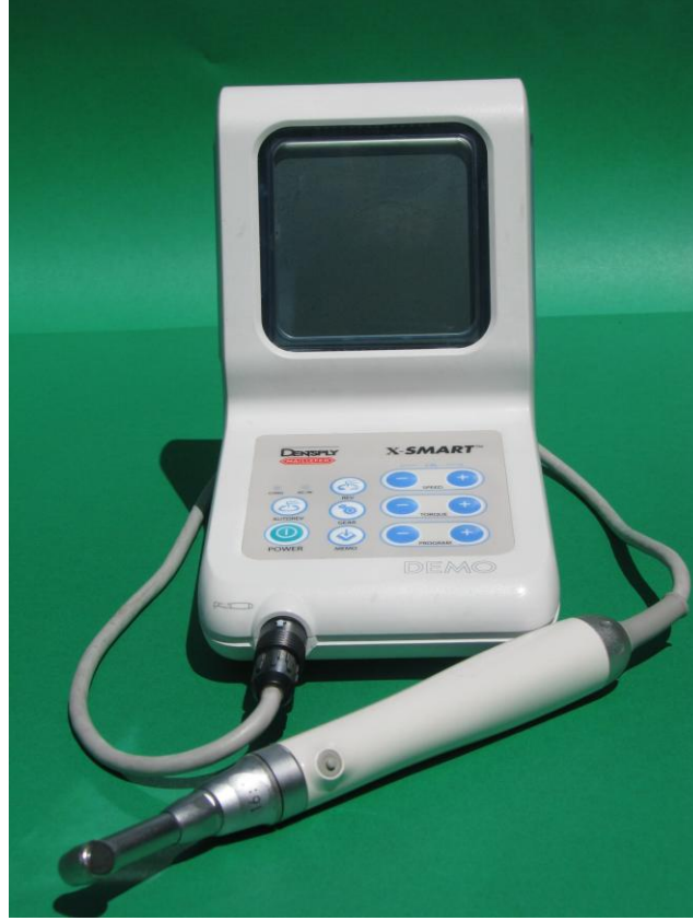
Resim 11: X-Smart tork kontrollü endodontik motor ve angldrüva
