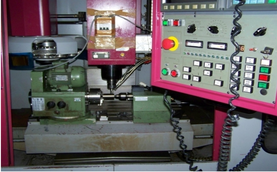
Şekil 3.1 Teğetsel tornalama-frezeleme deney düzeneği fotoğrafı
