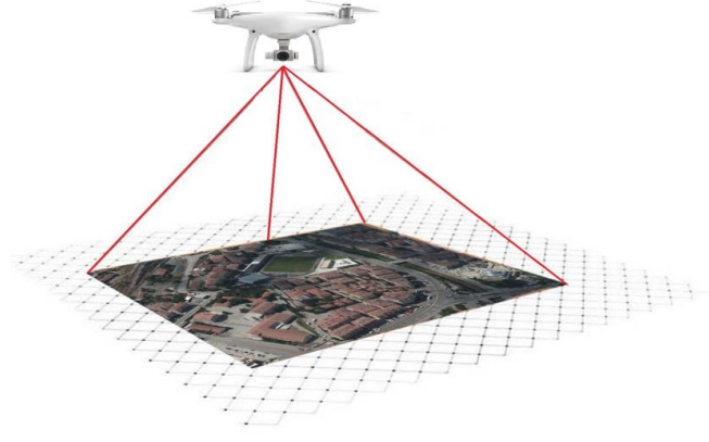
Şekil 8.11. İHA ile hava fotoğraflarının çekilmesi
