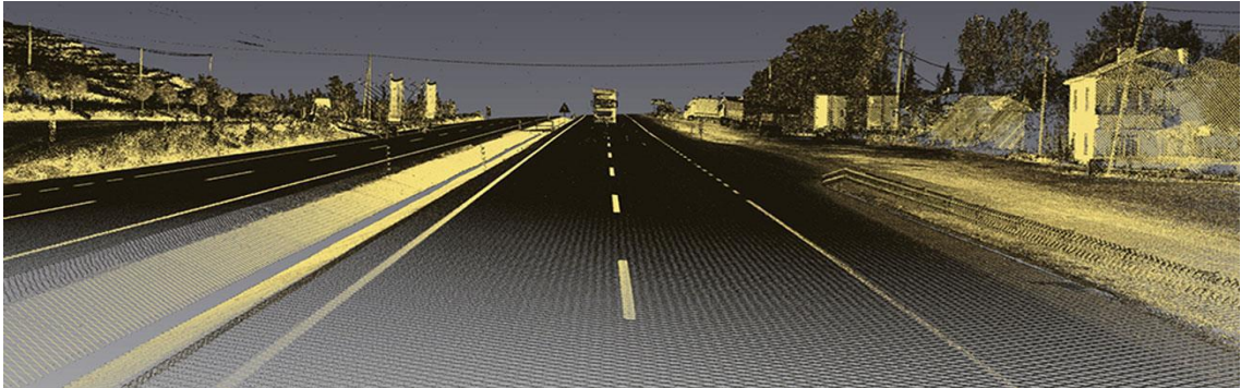
Şekil 7.8. MLT sistemi ile yol yüzeyi çalışması (URL-26)
