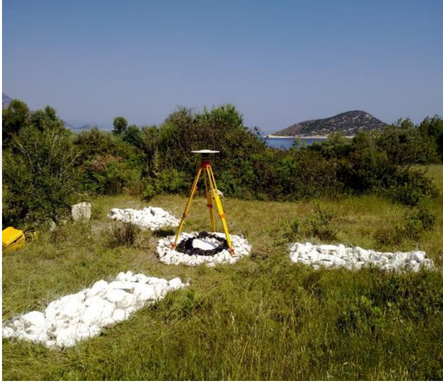
Şekil 6.10. Yer Kontrol Noktası Örneği (URL-16)
