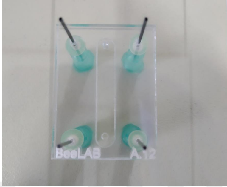
Şekil 2.14 DSA ve PMMA Katmanlarının Birleştirilmiş Görünümü
