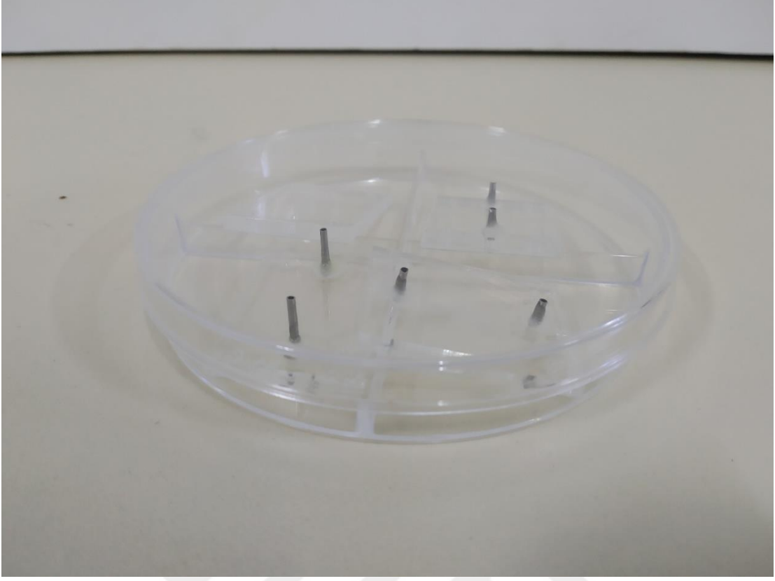
Şekil 2.26 Petri Kabına Yerleştirilen Çipler
