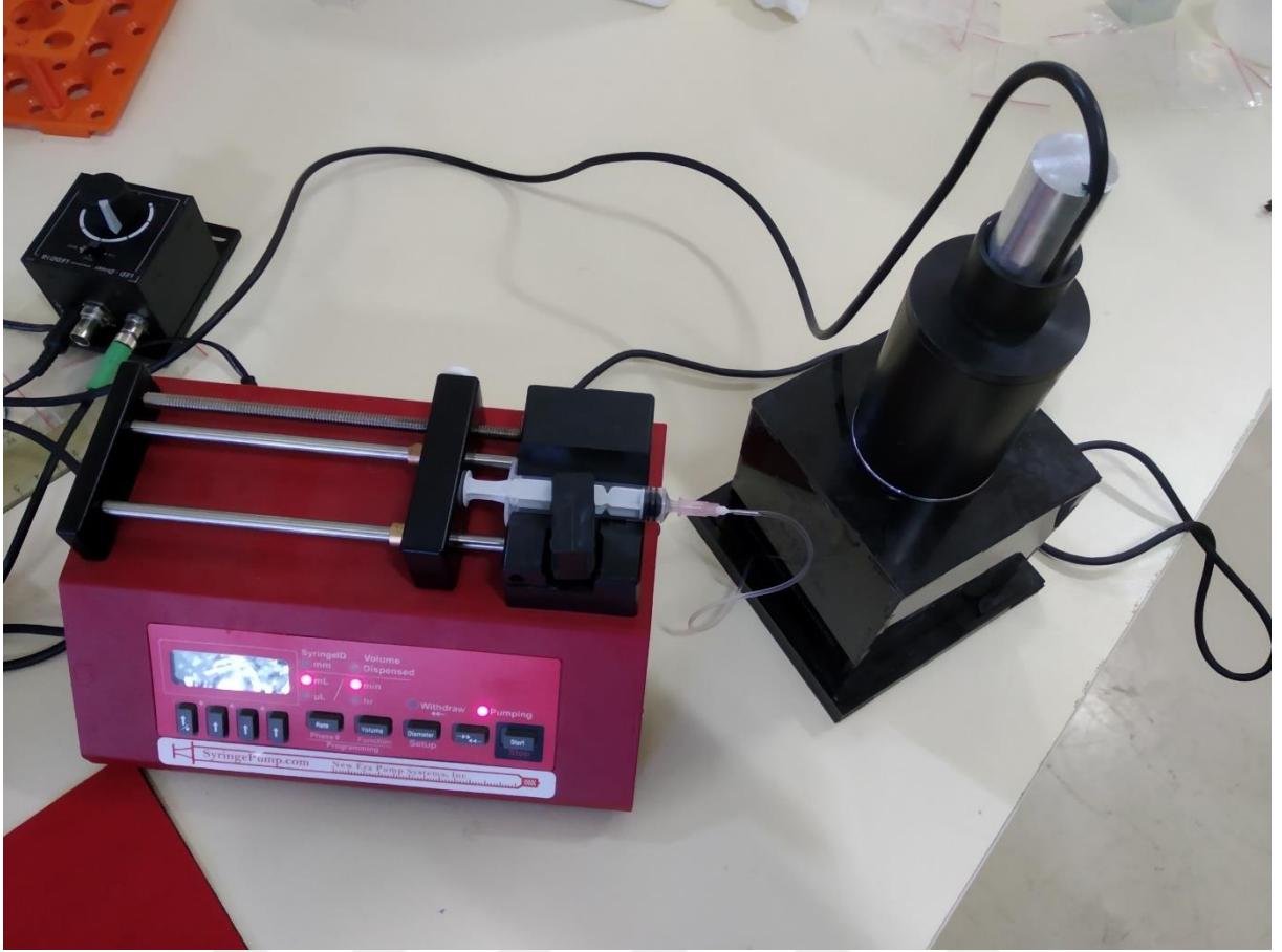
Şekil 2.36 Enjeksiyon Pompası ve Gölge Görüntüleme Sistemi
