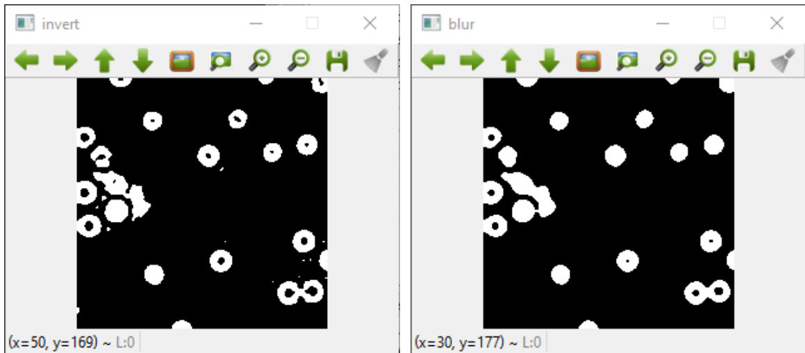
Şekil 2.51 Binary Görüntü ve Filtrelenmiş Binary Görüntü
