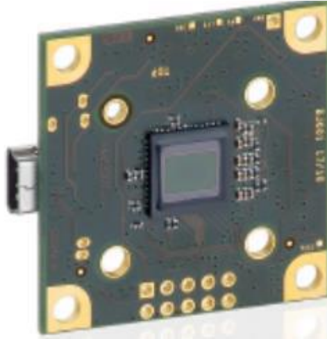
Şekil 2.28 Görüntü Sensör CMOS Kamera
